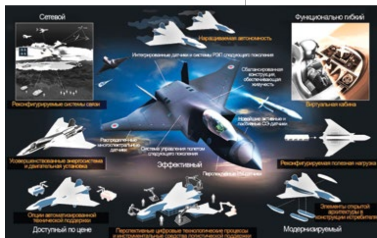
Рис. 3. Концепция будущего британского истребителя Tempest
