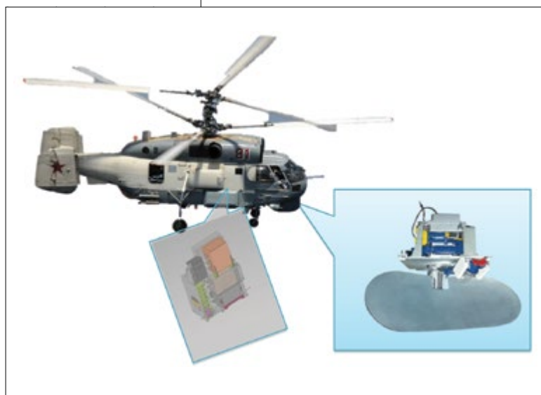
Рис. 6. Пример размещения одномодульной БРЛС на Ка-27
