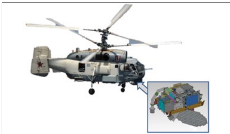
Рис. 1. БРЛС FNA01Э на вертолёте Ка-27М
