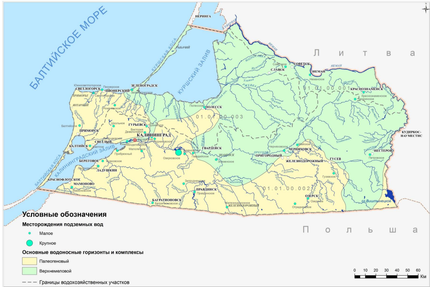
Рисунок 7.1 – Водоносные горизонты и месторождения подземных вод
