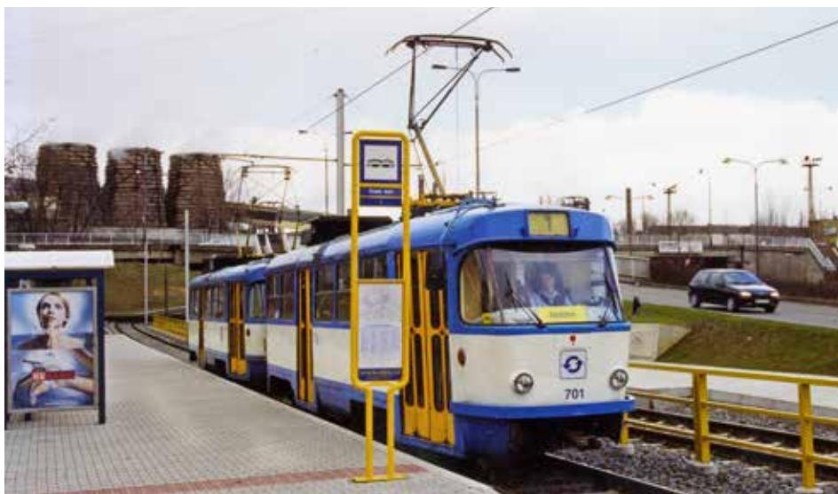
Po voze ev. č. 797 byl polopantograf ČKD Sécheron namontován na vůz T3M ev. č. 701, který s ním už dojezdil. Na fotografii jej vidíme společně s vozem ev. č. 717 dne 15. 3. 2000 v zastávce Český dům na tehdy nově zprovozněné tramvajové trati podél ulice Místecké. (foto: Adam Veselský)
