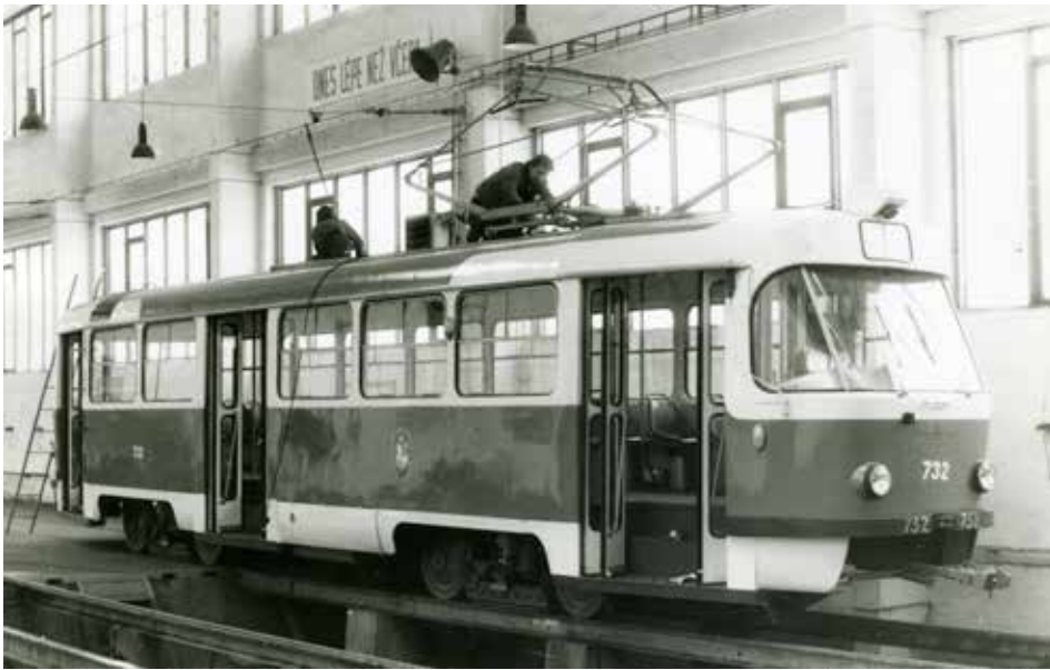
Oficiálně náhradní vozová skříň, ve skutečnosti však kompletní nové vozidlo. Za nehodou zničený vůz ev. č. 732 přišla náhrada v podobě vozu v provedení T3SU, který musel být před zařazením do provozu z větší části přizpůsoben našim podmínkám. Zrušena byla například střešní zásuvka nad linkovou orientací a nahrazeny byly i všechny ruské psané nápisy. Oproti tomu pedál „mrtvého muže“ zůstal zpočátku zachován, stejně jako uspořádání interiéru v kombinaci 2 + 1. Stejně vypadal po dodání i vůz ev. č. 777 l . (foto: Jindřich Sulek)
