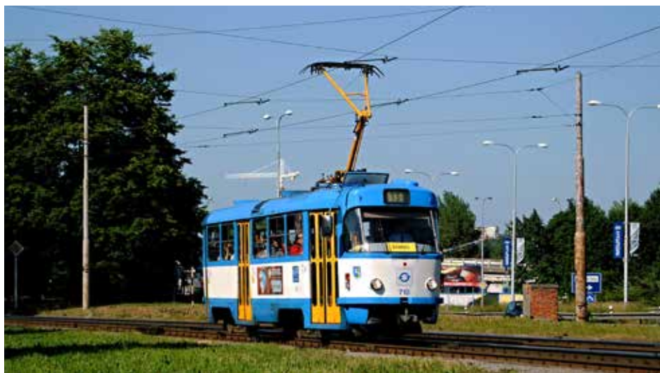
Vrcholem z hlediska modernizace elektrické části byla modernizace dvojice vozů ev. č. 710+718 za užití výzbroje TV8 na typ T3G. Oba vozy byly přesto vyřazeny z provozu. Na fotografii je sólo vůz ev. č. 710 nedaleko zastávky Důl Hlubina. (foto: Roman Havko)
