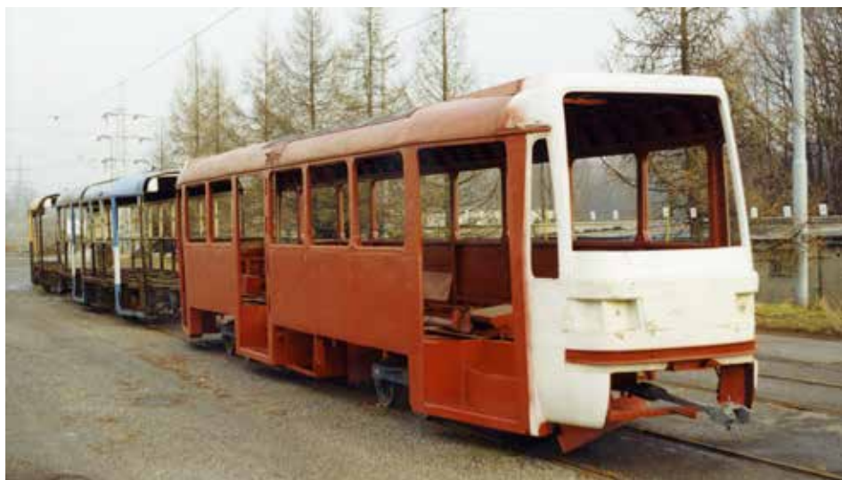
Tato fotografie představuje původně pražský vůz T3 ev. č. 6447, který byl vybaven čelou „Kotas“ a v Ostravě měla pro společnost Inekon proběhnout jeho modernizace společně s dalšími pražskými vozy ev. č. 6319, 6381 a ostravskými T3M ev. č. 710, 713 a 718. Z kontraktu pro Rusko ale nakonec sešlo. DP se rozhodnul použít vozy ev. č. 710 a 718 pro modernizaci na typ T3G, přičemž s ohledem na technický stav bylo rozhodnuto nahradit původní ostravský vůz ev. č. 718 pražským ev. č. 6381. Zbývající vozy stály dlouho odstavené v areálu dílen, než došlo k jejich likvidaci. Laminátová čela „Kotas“ byla z vozu ev. č. 6447 demontována a použita na ex-košický vůz ev. č. 355, který jezdí v lževsku. (23. 1. 1999; foto: Dušan Kuchař)
