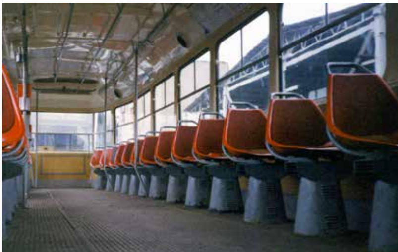
Interiér vozu T3 na konci 90. let s typickým vzorem imitace dřeva na bočním obložení a sedáky, na nichž byla nalepena podlahová krytina Jekor. Tovární kombinace střídavého uspořádání sedáků v červené a šedé barvě se už nedodržovala. (foto: Libor Hinčica)
