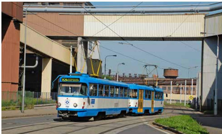
Vozy ev. č. 794+774 v soupravě PX projíždí dne 31. 8. 2009 během výluky Ruskou ulicí ve Vítkovicích. Obě tramvaje už s doplněnými brzdovými světly na čelech dojezdily. V provedení s velkým čelním transparentem představují obě vozidla nejvyšší stupeň provedených úprav na „klasických“ vozech T3 v Ostravě. (foto: Libor Hinčica)
