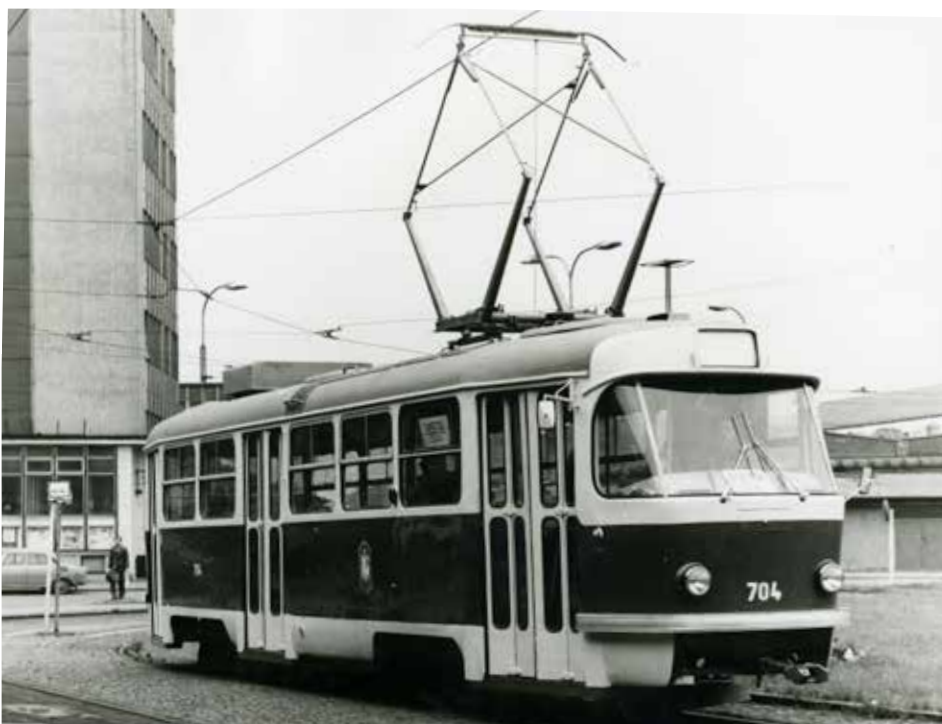
Vůz T3M ev. č. 704 na první zkušební jízdě po namontování nové elektrické výzbroje TV1. Na voze si lze povšimnout absence původních hliníkových lišt, nového typu uchycení zpětných zrcátek, odlišného provedení evidenčních čísel i původního provedení krytu brzdového odporáku. (smyčka Hlavní nádraží; foto: Jindřich Sulek)
