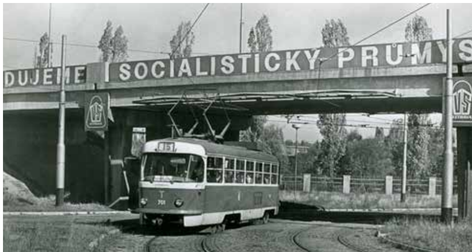
Vůz ev. č. 701 na propagačním snímku ostravského DP z roku 1979 projíždí pod mostem, po němž je vedena Plzeňská ulice a na kterém nechybí v té době nezbytná agitační výzdoba. Na čele vozu si můžete povšimnout velkého tiskacího „T“, které bylo zpočátku na všech vozech T3M a sloužilo jako upozornění, že se jedná o vůz vybavený tyristorovou výzbrojí. (sbírka: Libor Hinčica)
