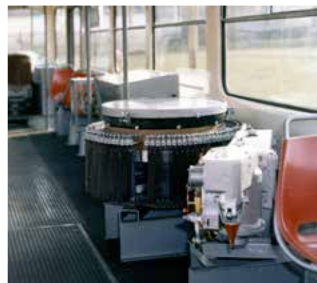
V interiéru cvičného vozu byly duplicitně osazeny komponenty elektrické výzbroje, což si vyžádalo demontáž části interiéru i zaslepení prostředních dveří vozu. (foto: Ing. Rudolf Pavelek)
