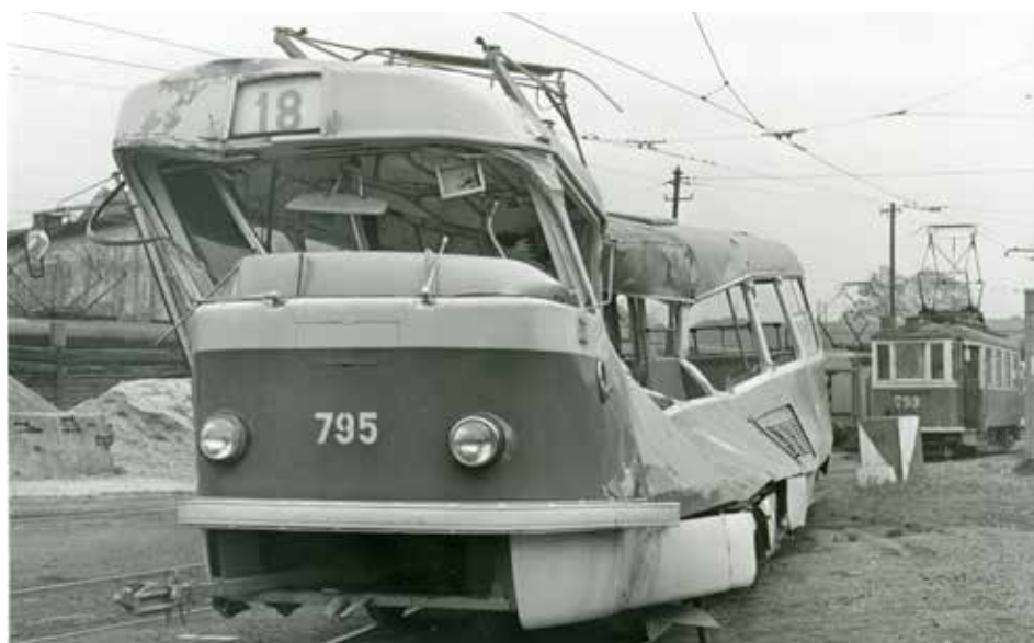
Nehoda vozu ev. č. 795 s domichávačem betonu vedla v roce 1981 k prvnímu poklesu stavu vozového parku vozů T3, neboť nebyla jako náhrada dodána nová vozová skříň. Beton, který se do tramvaje po nárazu vytil, byl ještě použit pracovníky vozovny k opravě zhlaví vozovny. (27. 10. 1981; foto: Ing. Rudolf Pavelek)
