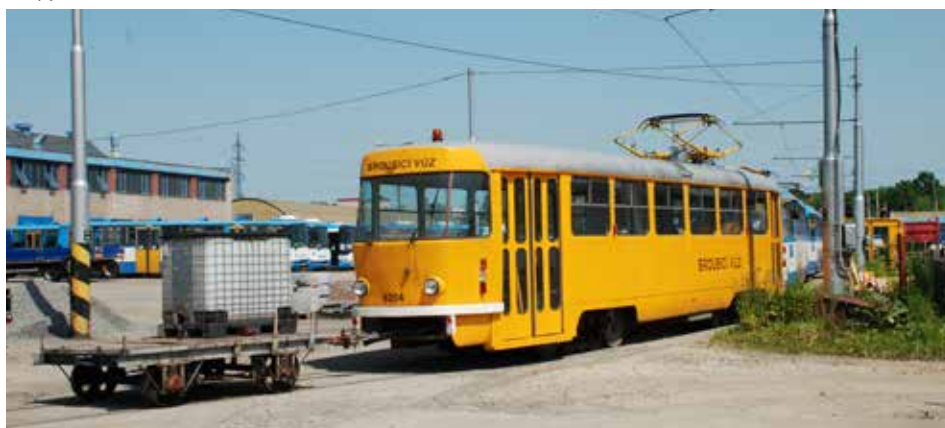
Rovněž původně pražský vůz (ex ev. č. 6535), který byl ovšem odkoupen už v roce 1991 a rekonstruován na brousíci (do provozu 1993). V současné době je jeho využití minimální. (12. 6. 2010; foto: Libor Hinčica)
