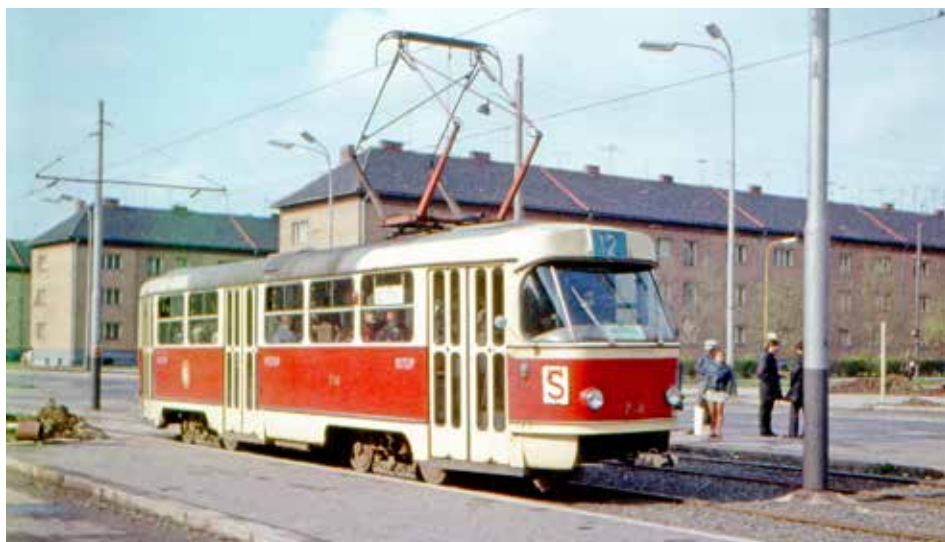
Vůz T3 ev. č. 714 na Horní ulici v Hrabůvce. Ze snímku je dobře patrné zavěšení cedule „S“ na čele vozu, které se používalo u všech vozů ze stanovištěm průvodčího. Pouze prvních 10 vozů a vozy počínaje ev. č. 758 byly dodány bez něj a měly „eSko“ nalakované přímo na karoserii. (24. 4. 1971; foto: Zdeněk Nesiba)
