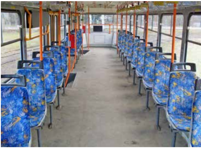
Dvě řešení interiéru vozů T3 v posledním provozním stádiu. První přibližuje vůz ev. č. 788 po malé modernizaci se sedáky 1+1 a oranžovými madly, šedě natřenou okenní částí a „mramorovým“ obložení (foto: Aleš Burakowski). Naopak bez modernizace, avšak s BUSE panely, byl vyfocen interiér vozu 757. Typické je obložení bočnic s imitací dřeva a sedáky se změkčenou sedací a operací částí (foto: Miroslav Halász).
