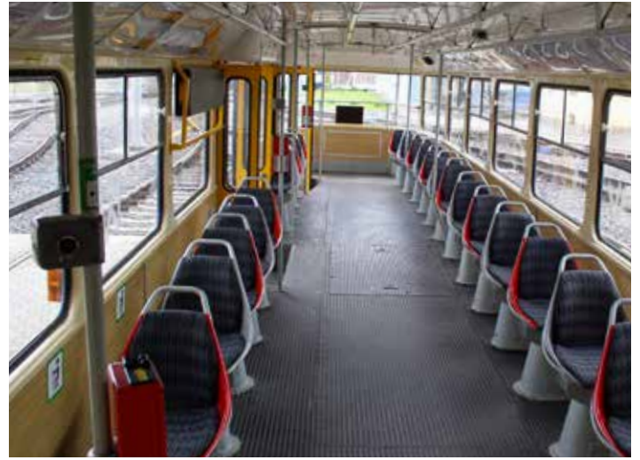
Dvě řešení interiéru vozů T3 v posledním provozním stádiu. První přibližuje vůz ev. č. 788 po malé modernizaci se sedáky 1+1 a oranžovými madly, šedě natřenou okenní částí a „mramorovým“ obložení (foto: Aleš Burakowski). Naopak bez modernizace, avšak s BUSE panely, byl vyfocen interiér vozu 757. Typické je obložení bočnic s imitací dřeva a sedáky se změkčenou sedací a operací částí (foto: Miroslav Halász).
