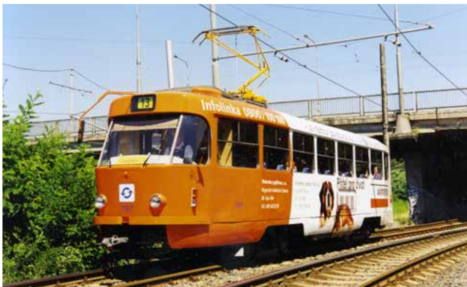
Vůz ev. č. 797 byl v letech 1997–99 provozován s polopantografem ČKD Sécheron, jenž byl atypický kloubem otočeným dozadu a ručním stahováním. Na fotografii je tramvaj už s reklamou na pojišťovnu Winterthur dne 4. 7. 1999 na trati pod mostem Mládeže. Za několik dní bude spojen do soupravy s vozem ev. č. 773 a polopantograf bude (kvůli zachování jednotného vzhledu soupravy) demontován. (foto: Adam Veselský)
