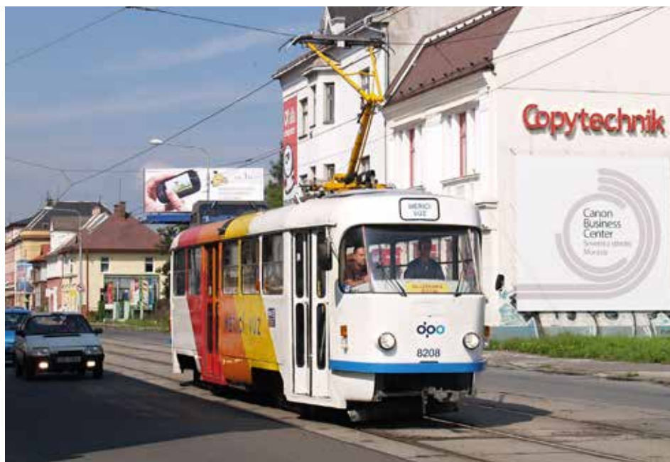
Vůz ev. č. 8208 byl v roce 1994 přestavěn na měřicí, když se jeho původní využití jako jídelní v praxi neuplatnilo. V rámci rekonstrukce bylo použito stejné barevné schéma, jaké má i cvičný vůz ev. č. 8201. Na fotografii projíždí ulicí 28. října v Mariánských Horách. (27. 7. 2011; foto: Vojtěch Zdražil)
