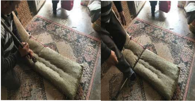
Fotoğraf 24. . V demiri ile katlama işlemi (Kılıç Karatay, 2019)
