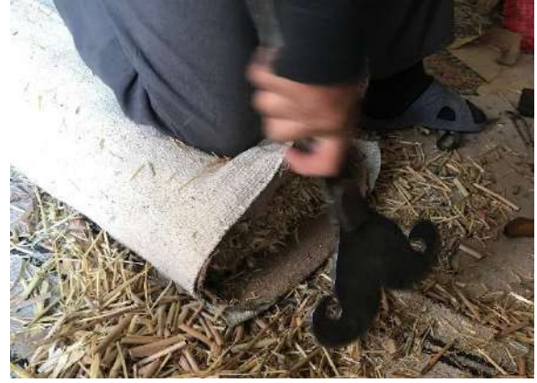
Fotoğraf 20. Uçların kurt ağzı ile sıkıştırılması (Kılıç Karatay, 2019)
