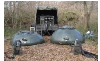
海水の飲料水化も可能とする浄水濾過システム
