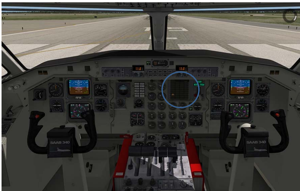
Esquema de la cabina de vuelo, donde se detalla la ubicación del panel central de alarmas.
