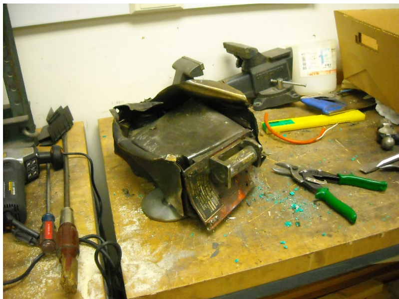
Estado del equipo CVR al momento del desarme.
