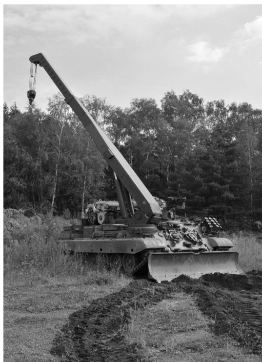
Rys. 4. WZT-4 podczas prób terenowych (widoczny na skrzyni ładunkowej zamienny power pack)
