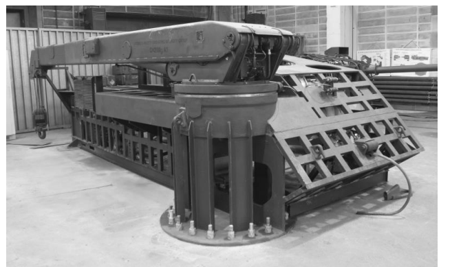
Rys. 14. Imitator zespołów roboczych Wozu Zabezpieczenia Technicznego
