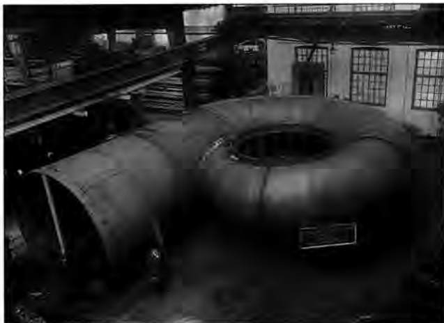
Ett av spiralskåpen till Norrfor kraftverk under tillverkning vid Verkstaden, Kristinehamn, på 1920-talet. Foto i Kraftverksföreningens arkiv, Stockholm.
