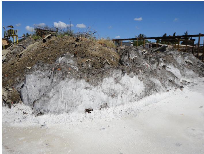
Figure 22 : plateforme de stockage des boues de saumure
