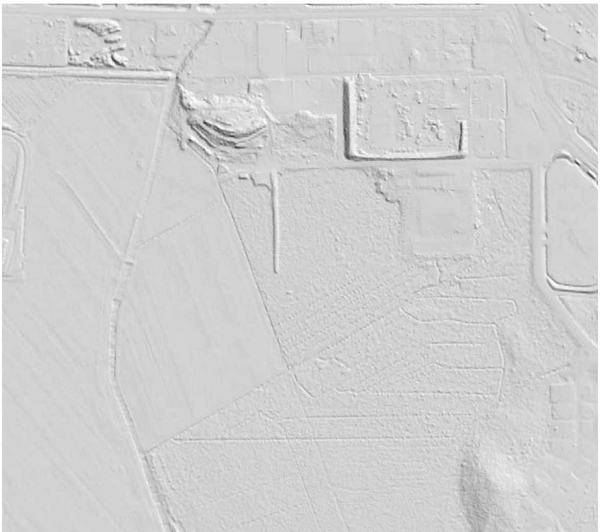
Kuva 9. Maanmittauslaitoksen laserkeilausaineistosta muodostettu Parooninmäen aluetta kuvaava bittikarttakuva. Kuvasta erottuu hyvin alueen länsiosan peltoaukea sekä muun kaava-alueen ojitettu metsäalue.
