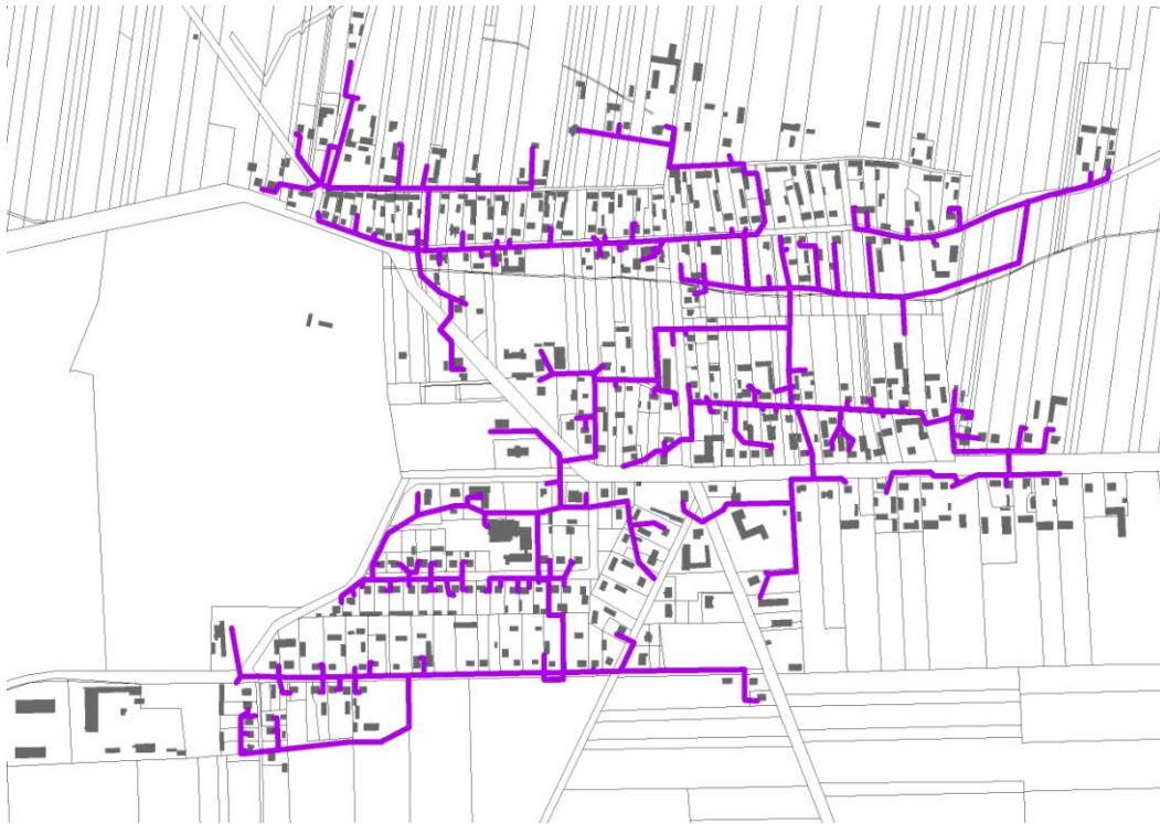
Ryc. 71 Schemat sieci kanalizacyjnej w miejscowości Repki
