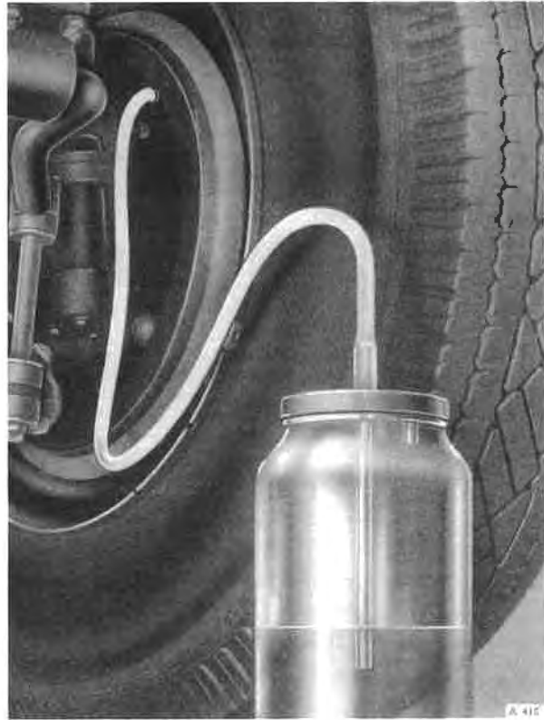
Fig. G3 'Bleeding' front brakes
