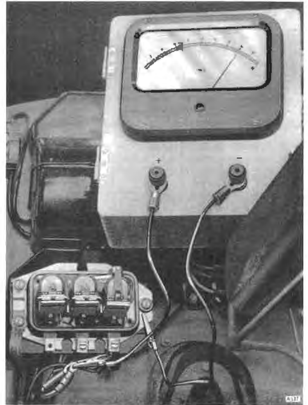
Fig. M5 Generator voltage test
