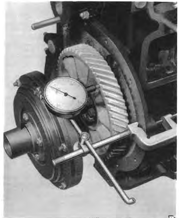
Fig. E10 Checking camshaft end float
