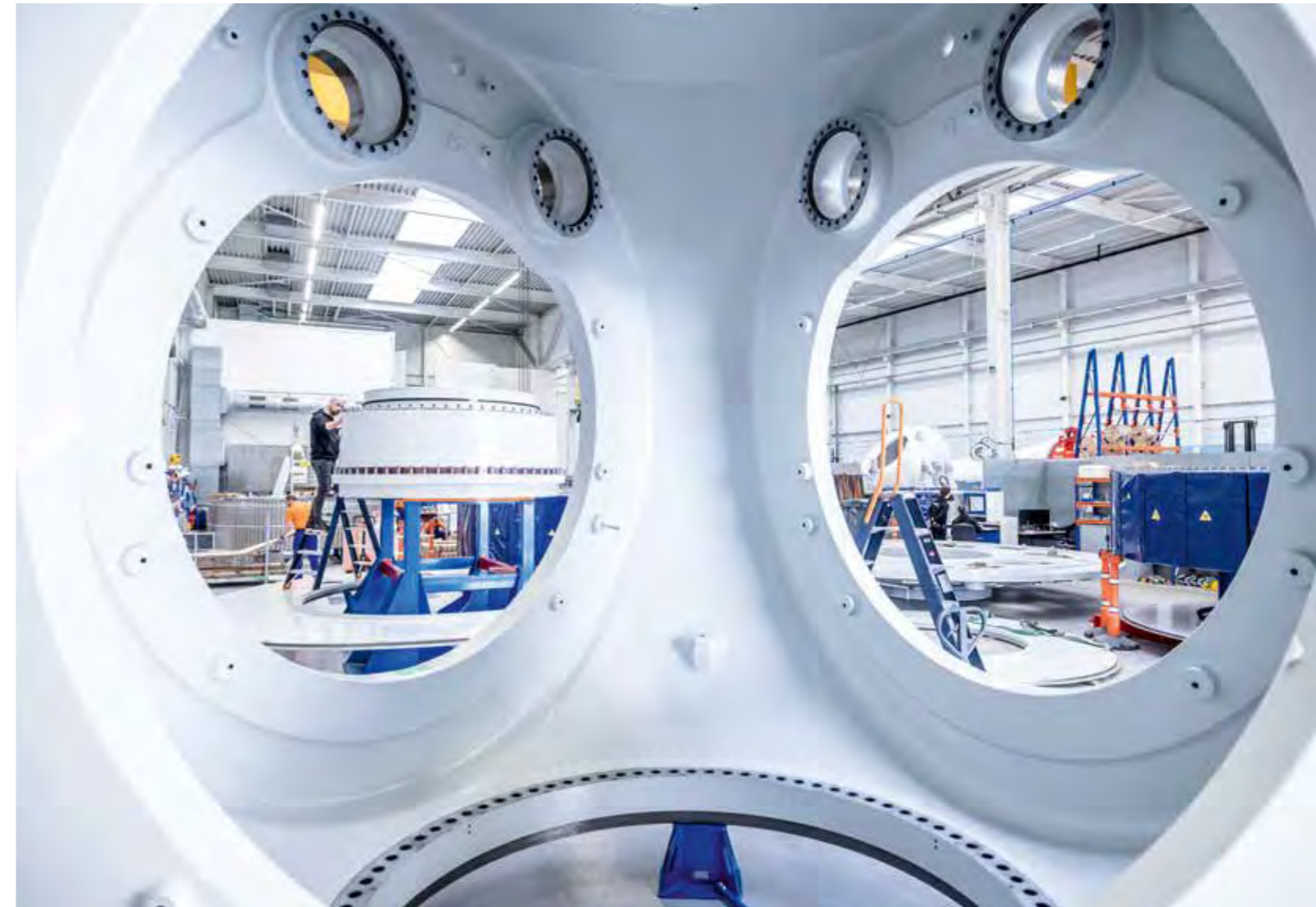
› Die Rotornabe für den Prototyp der E-160 EP5 ist für den Einbau vorbereitet.
