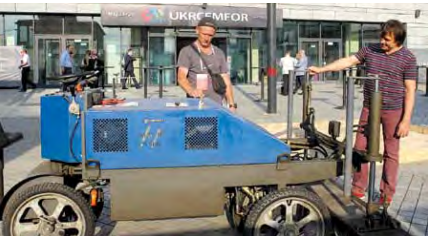
Бетоноукладальник MANIPAV працює за системою лазерного наведення і електронного програмування
