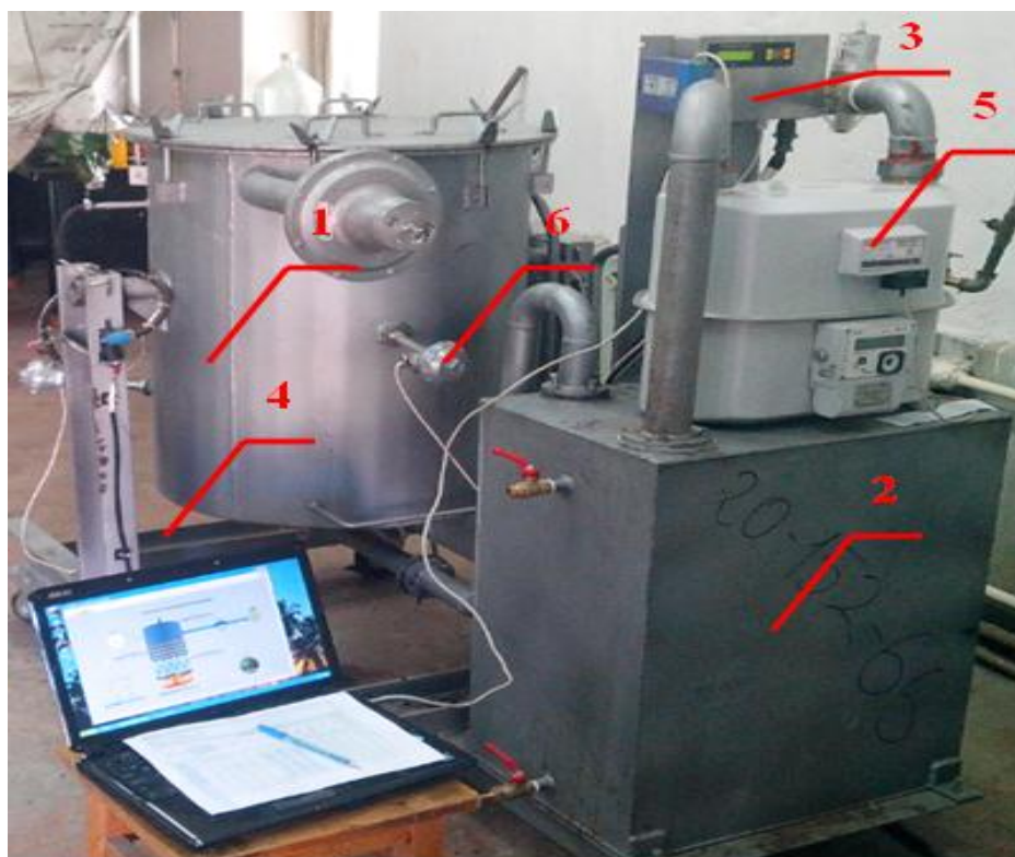
Рис. 1. ГВА-1: 1 – термореактор, 2 – гидрозатвор, 3 – электронный блок контроля и управления, 4 – рама, 5 – газовое оборудование, 6 – датчики температуры
