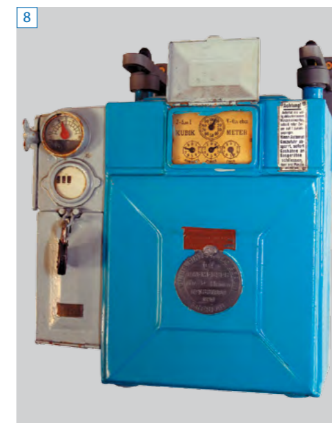
fot. 1-8. (1) Gazomierz laboratoryjny, (2) gazomierz miechowy „KROMSCHRÖDER” 1918 r., (3) gazomierz skrzynkowy kontrolny, (4) gazomierz na żetony „J. Pintsch” – 1914 r., (5) gazomierz kontrolny „J. Pintsch”, (6) gazomierz okrągły „J. Pintsch” – 1939 r., (7) gazomierz firmy „Elster” 1896 r., (8) gazomierz na żetony „Pintsch” – 1920 r. – Muzeum Gazownictwa w Paczkowie. (1) A laboratory gas meter, (2) a “KROMSCHRÖDER” bellows gas meter – 1918, (3) a box gas meter, (4) A “J. Pintsch” token gas meter from 1914, (5) a “J. Pintsch” control gas meter, (6) a “J. Pintsch” round gas meter from 1939, (7) a gas meter by “Elster” Company – 1896, (8) A “Pintsch” token gas meter from 1920 – Gas Industry Museum in Paczków.
