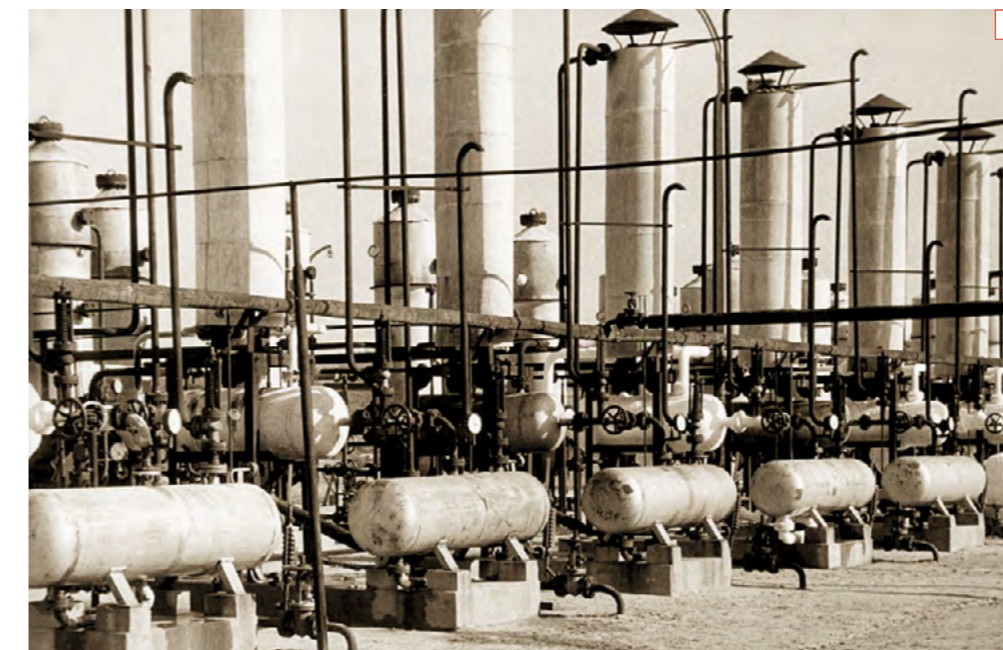
fol 1. Osuszacze gazu metodą kolumnową w Lubaczowie. Dehydration of gas in columns in Lubaczów.
