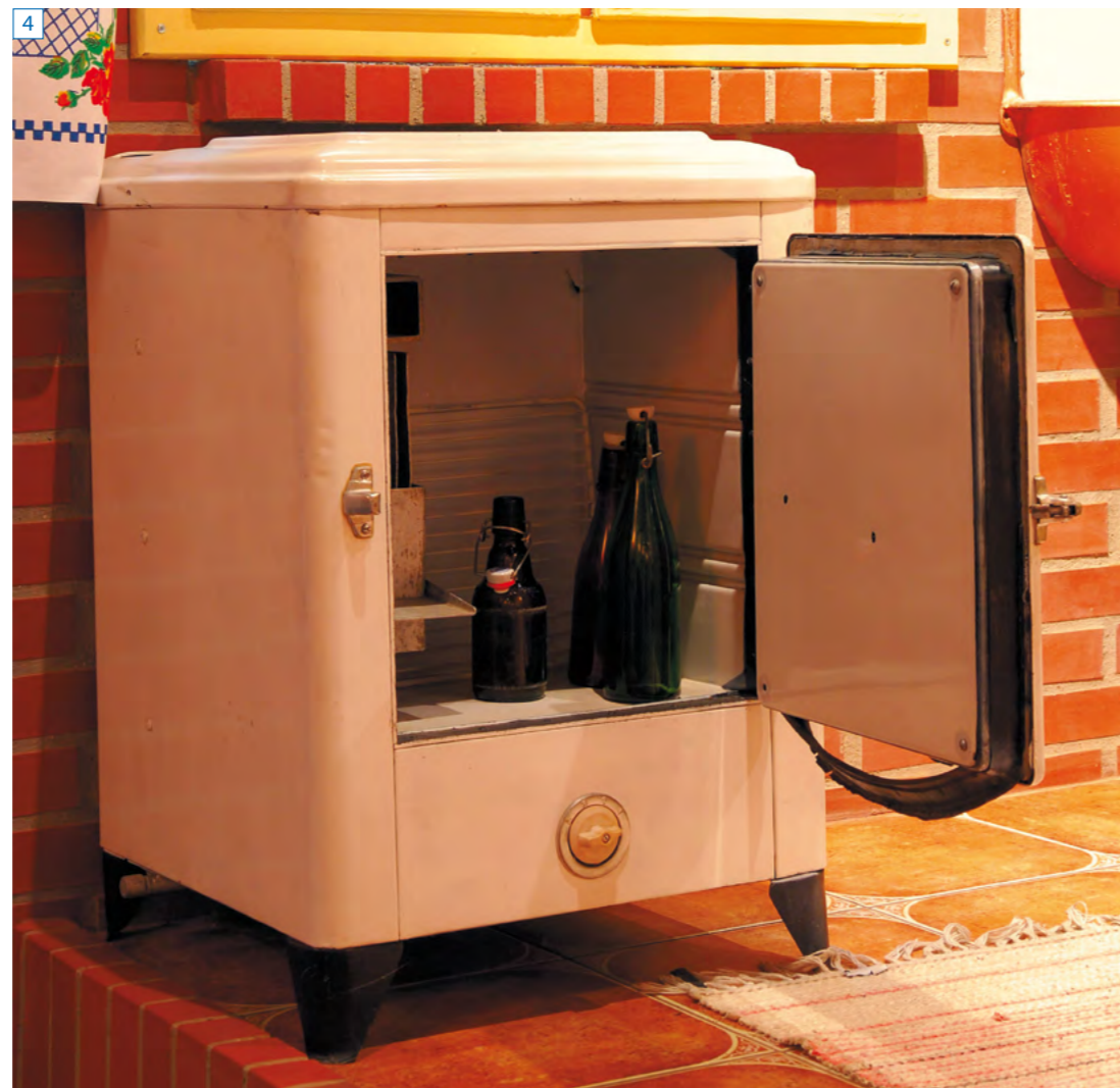
fot. 4. Lodówka gazowa do działania wykorzystuje zasadę absorpcji. Amoniak wytrącany jest z wodnego roztworu w podgrzewanym palnikiem gazowym wurniku, skąd przedostaje się do chłodzonego powietrzem skraplacza; następnie – już jako ciecz – do parownika we wnętrzu komory chłodniczej, gdzie parując odbiera ciepło od otoczenia. Opary amoniaku są następnie absorbowane przez wodę w pochłaniaczu. Roztwór wraca do wurnika. – Muzeum Gazownictwa w Paczkowie.
