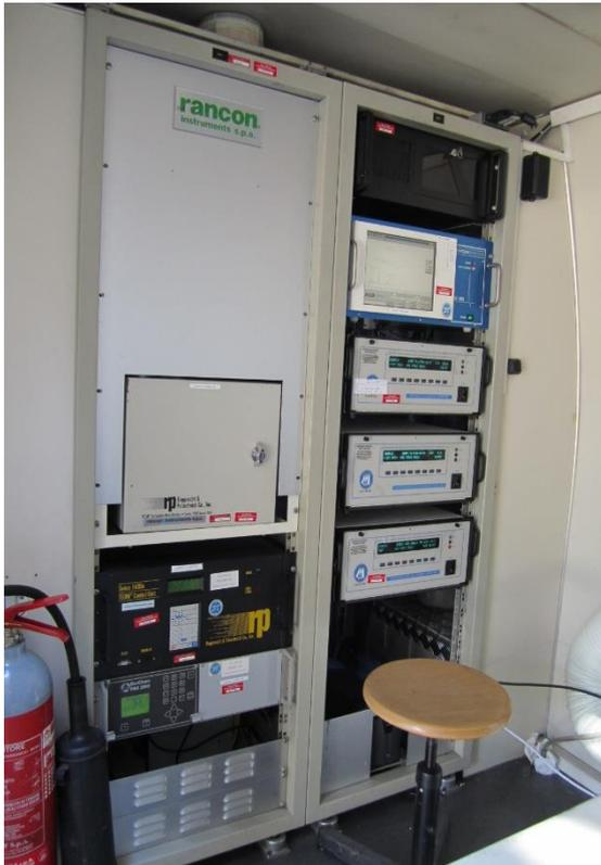
Il laboratorio mobile ha permesso la quantificazione degli inquinanti: **Monossido di carbonio (CO), Benzene, Toluene, Polveri PM10, Idrocarburi policiclici aromatici (IPA) totali.** Mediante sensori meteo è stato possibile monitorare contemporaneamente anche gli andamenti di **velocità e direzione del vento.**
