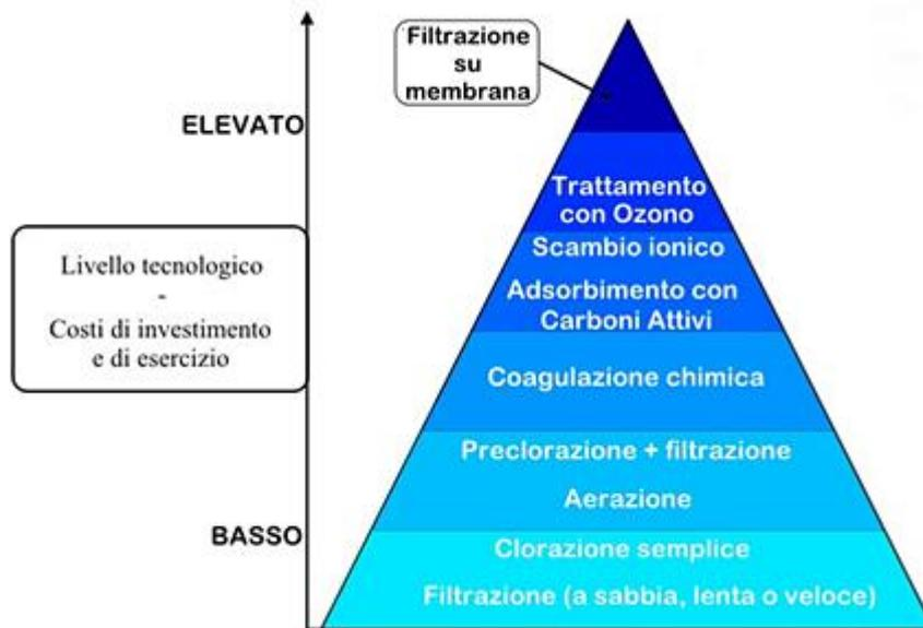
Figura 1. Complessità e costo delle tecnologie dei sistemi di potabilizzazione delle acque
