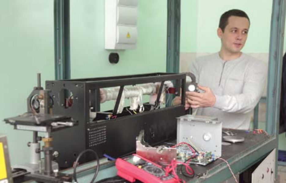
Научный сотрудник, к.т.н. М.В. Тригуб и высокоскоростной усилитель яркости на парах бромида меди (совместная разработка ИОА СО РАН и ТПУ)
