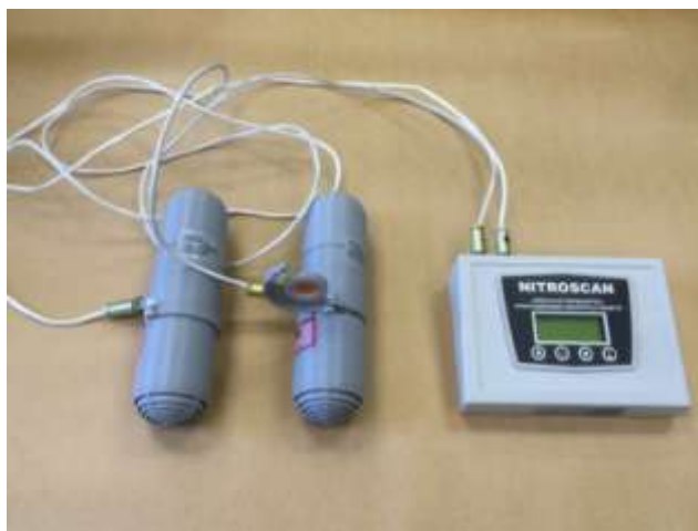
Рисунок 4.7 – Внешний вид макетного экземпляра многоканальной системы детектирования паров взрывчатых веществ
