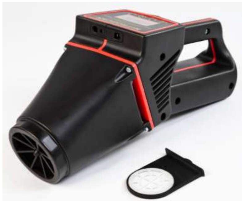
Рисунок 4.4 – Внешний вид экспериментального мобильного детектора взрывчатых веществ
