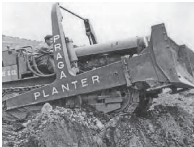
↕ Pásové traktory Praga s rozhrnovacími pluhy
