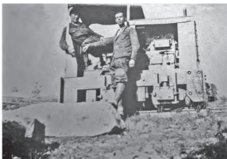
↕ Motorová lokomotiva značky Orenstein & Koppel typ MD-2. V popředí snímků jsou kamenné kvádry určené pro stavbu dálničních mostů
