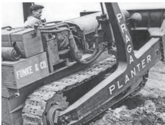
↕ Pásové traktory Praga s rozhrnovacími pluhy
