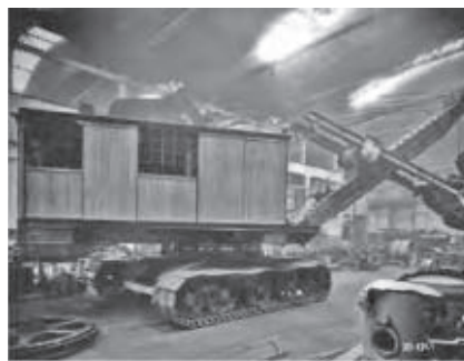
Téměř dokončené rypadlo Škoda typ D – 1.5 objednané firmou Funke & Co na stavbu dálnice
