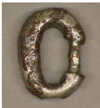
Figura 43 . Alteración del metal constituyente.
