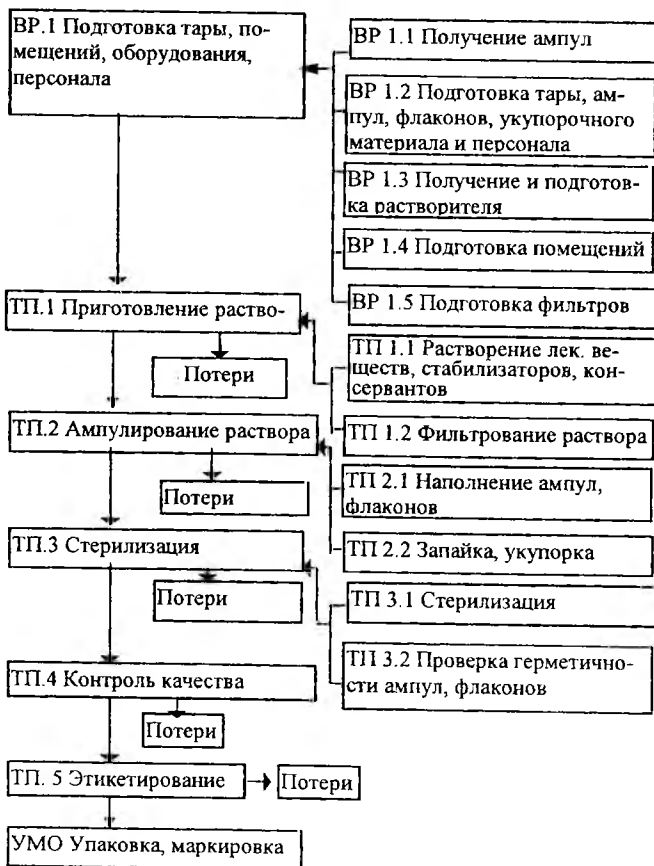
Рис. 3.34. Технологическая схема асептически изготавливаемых, стерильных ампулированных препаратов.
