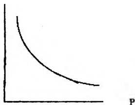
Рис. 3.21. Зависимость пористости таблеток от давления прессования.
