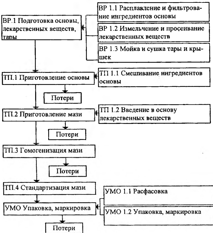
Рис. 3.79. Примерная технологическая схема производства мазей.
