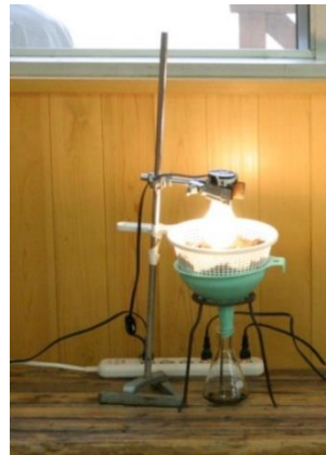
写真 IX-6 ツルグレン抽出法 (簡易装置)
