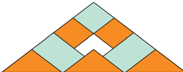
Slika 2.50. Šematski prikaz deponovanja po Windrow metodi
