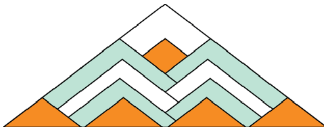
Slika 2.52. Šematski prikaz deponovanja po Shevron-Windrow metodi
