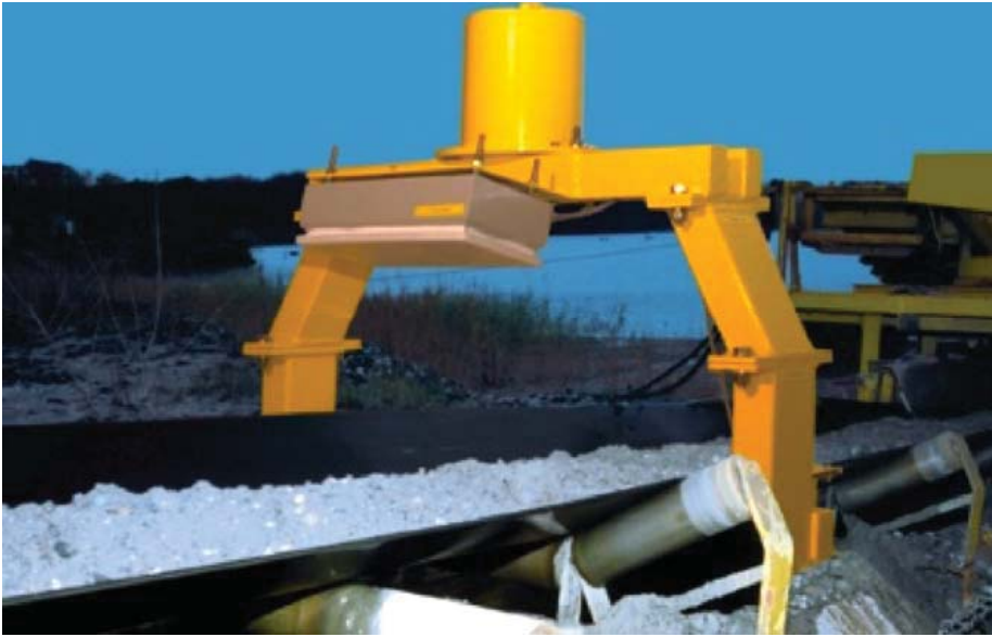
Slika 2.37. Merač vlage montiran nad transporterom
