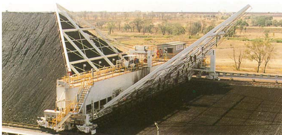
Slika 2.56. Uzimanje uglja sa portalnim deponijskom mašinom
