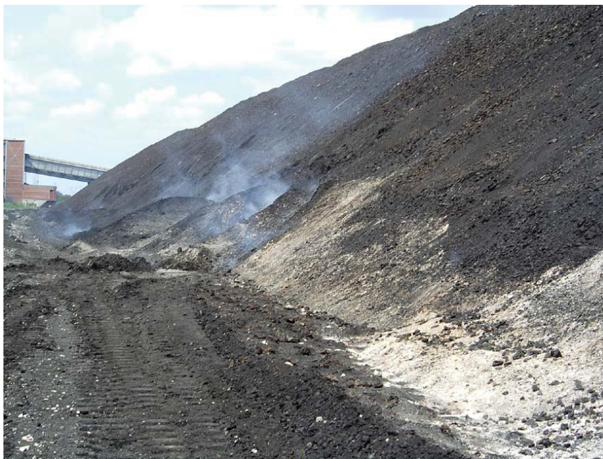
Slika 4.6. Vizuelna manifestacija samozapaljenja uglja na deponiji termoelektrane Kostolac B
