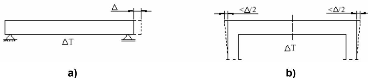
Fig. 3.22 Deplasări din variații de temperatură a) Pod clasic cu o deschidere b) Pod cu culee integrate
