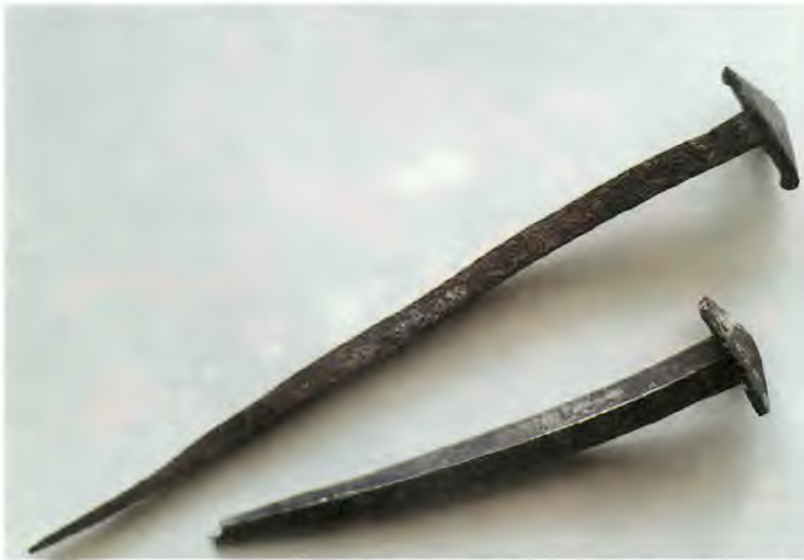
Nägel von der unteren Schlossscheune, 19. Jahrhundert. Bis ins 20. Jahrhundert hinein wurden auch in Oberdiessbach noch Nägel von Hand geschmiedet.
