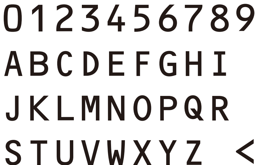
图 4 用于机读旅行证件的选自[ISO 1073-2]的 OCR-B 字符子集
