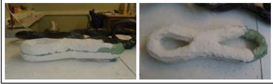
Resim 14: İki yarım kalıp birleştirilerek tek kalıp elde edilmiştir.
