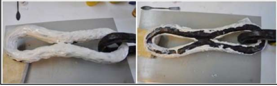
Resim 10: Silikon ile yüzey kaplama işlemi.
