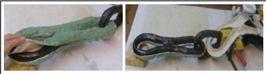
Resim 12: Sürülen silikon kaplama yatay iki parçada kesilmiştir.
