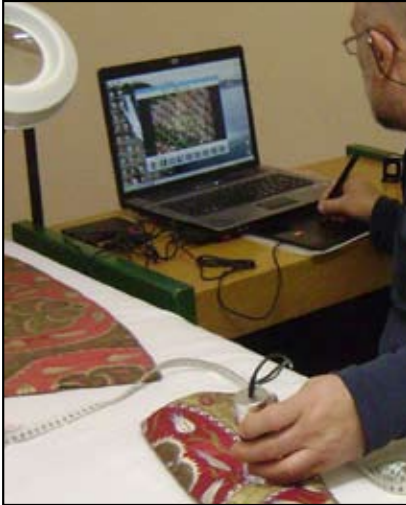
Resim 6, 7: USB girişli dijital el mikroskobu ile ip ve örgü analizinin yapılması ve fotoğraflanması.
