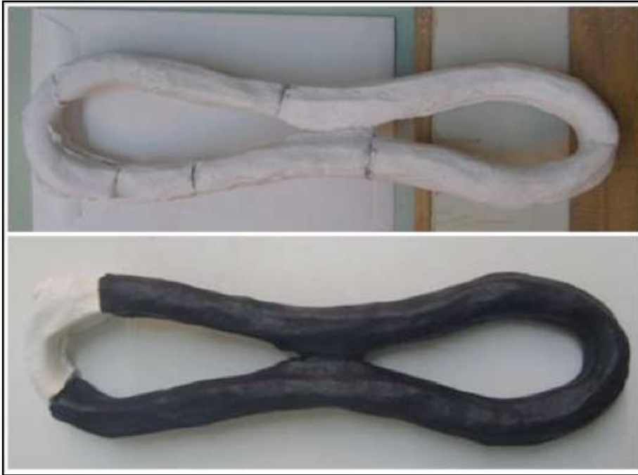
Resim 15: Tam kalıbın içine alçı döküm yapılmıştır. Siyah renge boyanan döküm, birleşim yeri ile birlikte iki parçadan oluşmaktadır.
