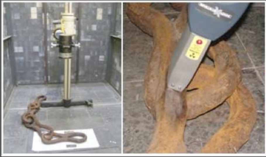
Resim 6: Radyografik görüntüleme ve XRF element incelemesi.
