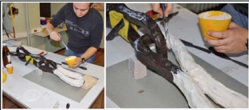
Resim 9: Kalıp alma çalışmasında ayırıcı ile yüzeye sürülen silikonun uygulaması.
