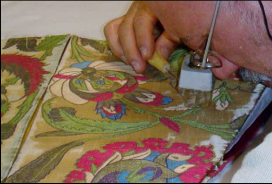
Resim 2: Loop ile atkı ve çözgü iplik sıklıklarının analizi.
