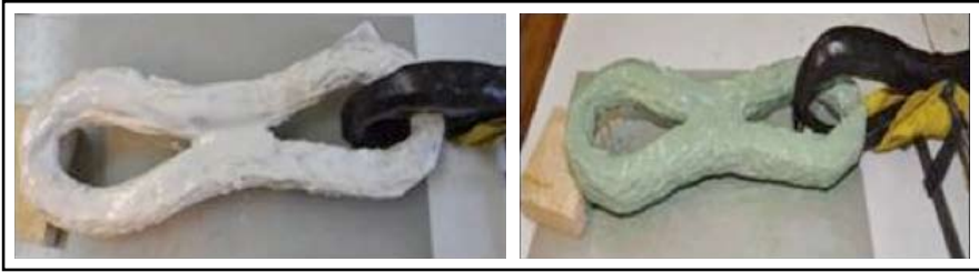
Resim 11: İkinci silikon katı ayırt edici olması için yeşil renkte hazırlanarak uygulanmıştır.
