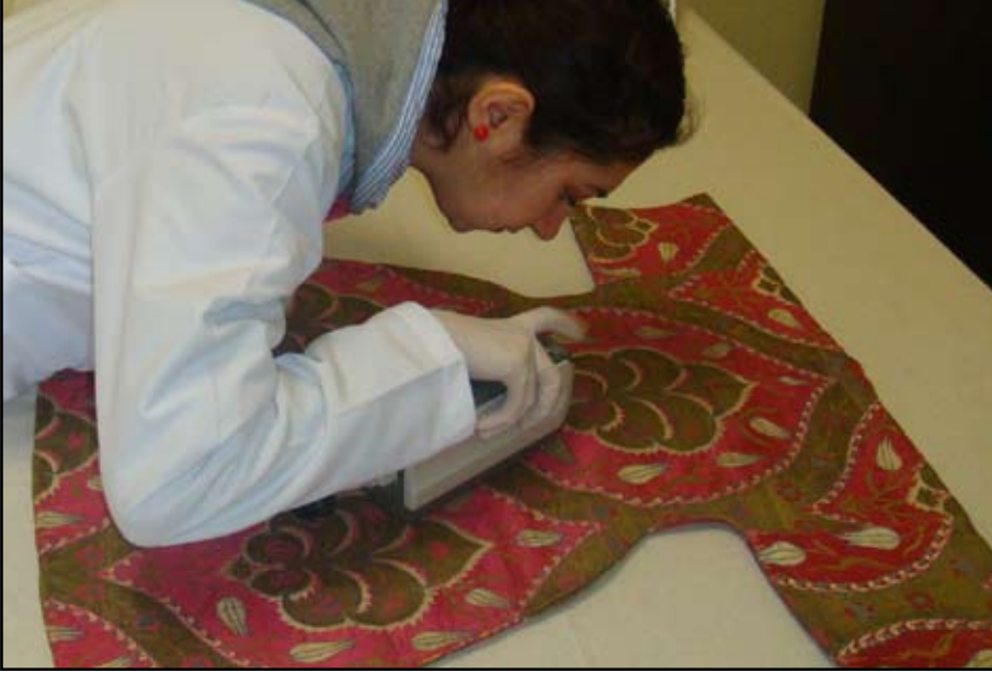
Resim 1: CIE L*a*b* renk uzayı olarak adlandırılan spektrofotometre ile renk ölçümleri yapılması.
