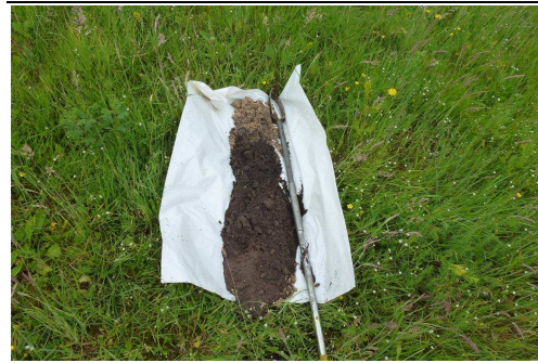
Foto's boorprofielen bepaling dikte afdeklaag
