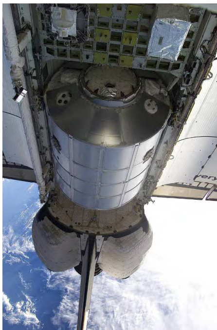
Víceúčelový logistický modul „Leonardo“ v nákladovém prostoru raketoplánu letícího k Mezinárodní vesmírné stanici 10. března 2001 během mise STS-102. Konstrukce těchto víceúčelových logistických modulů se stala předlohou i pro konstrukci laboratorního modulu Columbus.
