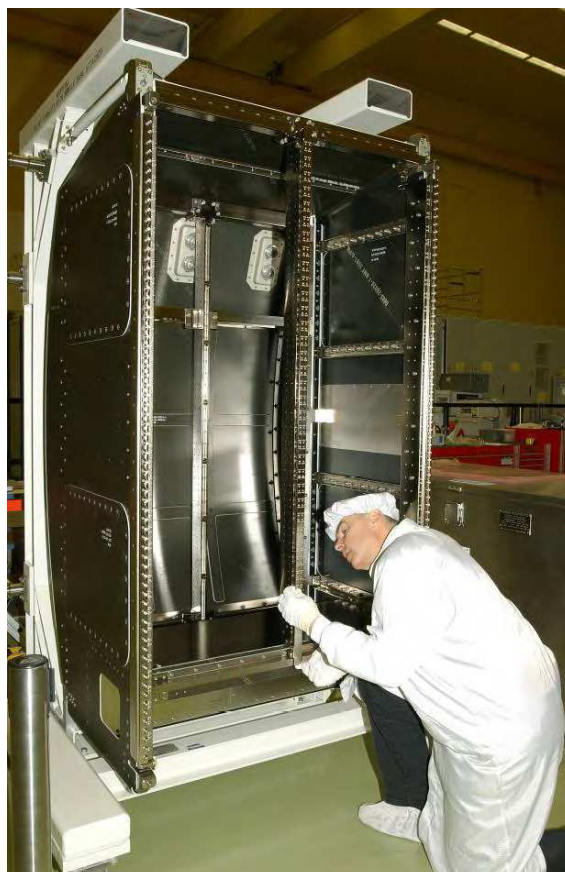
Mezinárodní standardní skříň, do které mohou být uloženy vědecké přístroje, různé podsystémy nebo prostě jen zásoby.
