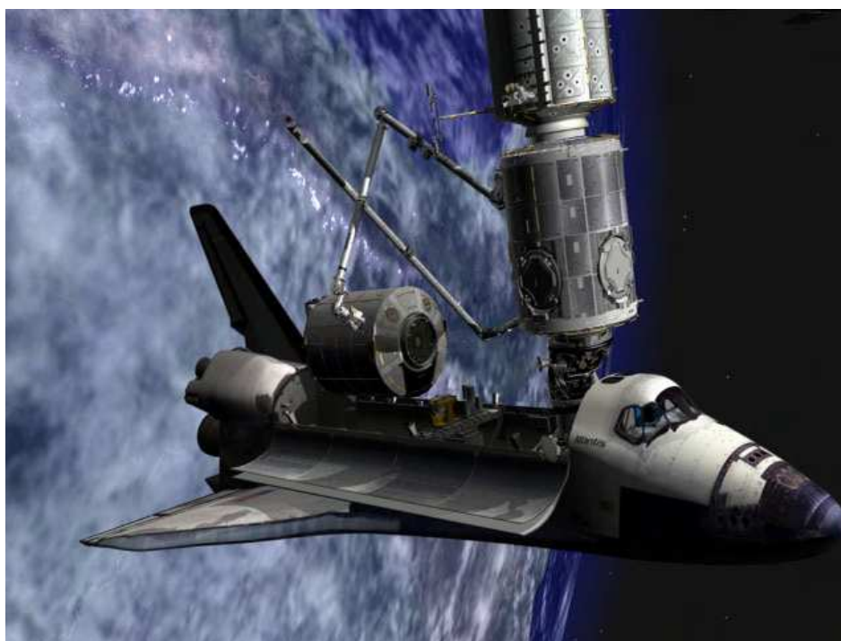
Obrázek ilustruje uchopení laboratorního modulu Columbus pomocí dálkově ovládaného manipulátoru Canadarm2 v rámci příprav na jeho připojení k Mezinárodní vesmírné stanici.
