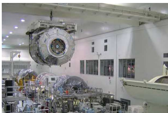
V Evropě vyrobený modul Node 2 je zavěšen na jeřábu při jeho přemísťování pro provedení těsnostních zkoušek v hale pro přípravu zařízení pro Mezinárodní vesmírnou stanici v Kennedy Space Center na Floridě. Modul Node 2, nazvaný také Harmony byl připojen k Mezinárodní vesmírné stanici během mise STS-120 v říjnu 2007.
