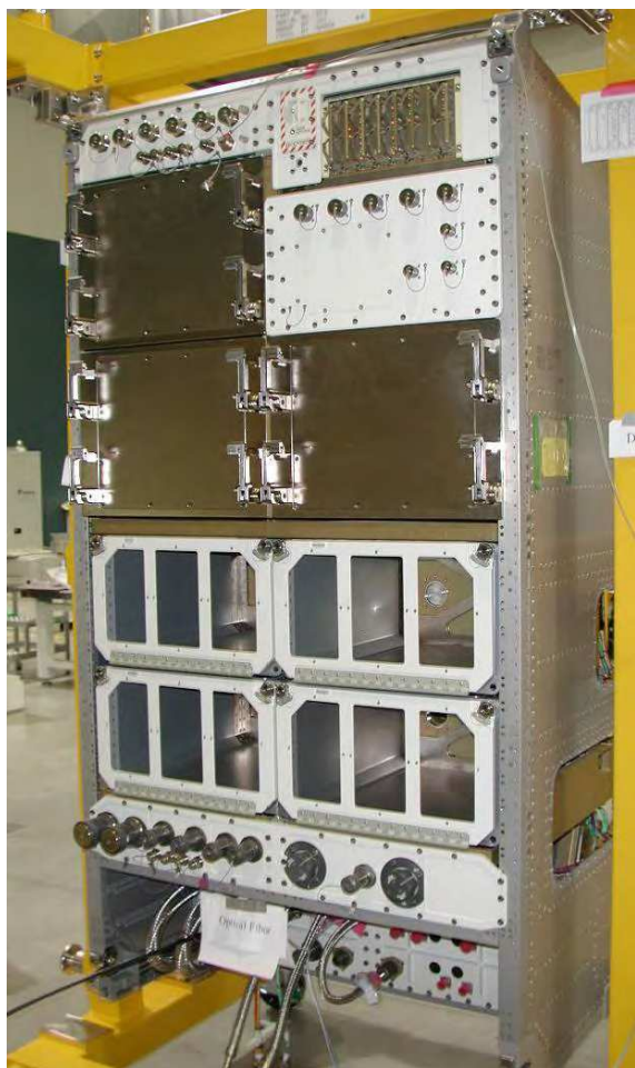
Skříň pro experimenty s jasně patrnými třemi standardními zásuvkami a čtyřmi standardními přihrádkami.
