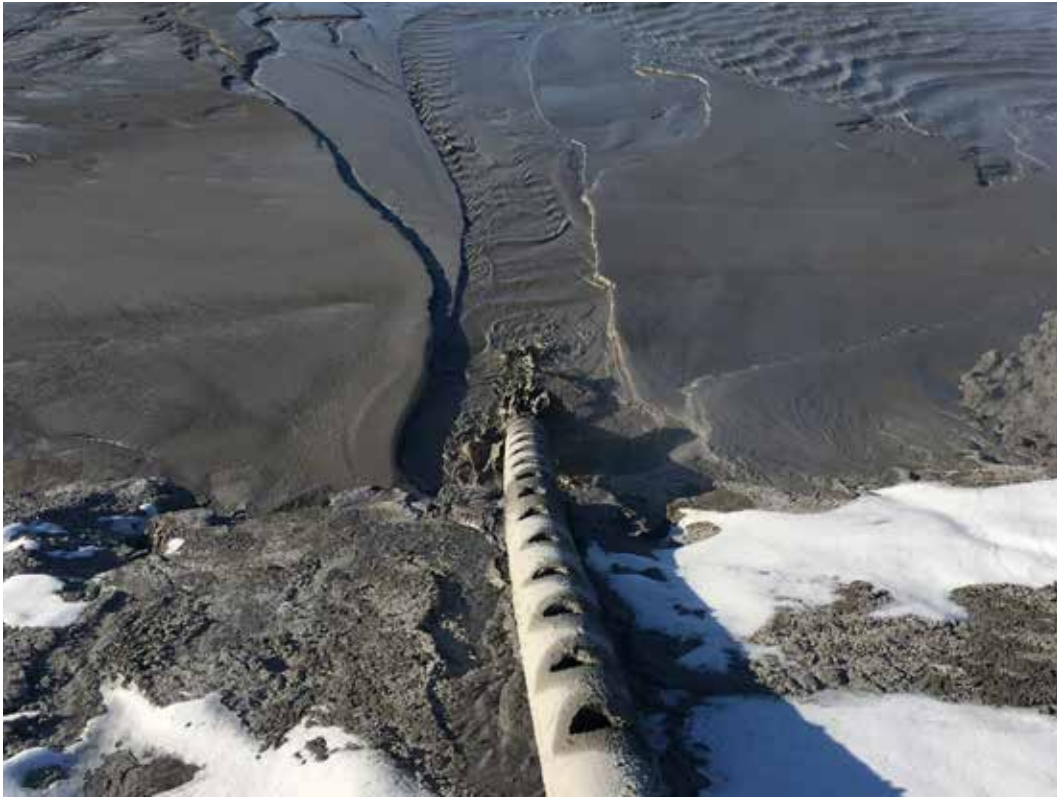
Deponering genom spigottering vid användning av s.k. droppipes, vilka används vid deponering från damm med högt fribord mot sandytan.
