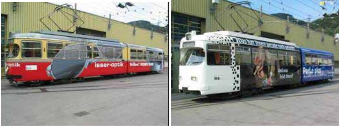
Abbildung 40: links:6-achsiger Lohner Triebwagen mit 3 Drehgestellen im Stadtverkehr - (Einrichtungsfahrzeug)
