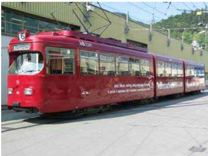
Abbildung 41: 8-achsiger Hagerer Triebwagen mit 4 Drehgestellen auf der Stubaitalbahn (Zweirichtungsfahrzeug)
