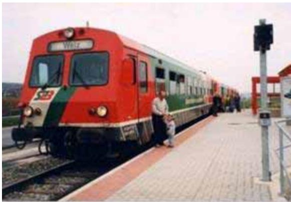
Abbildung 8: Dieselelektrischer Normalspurtriebwagen
