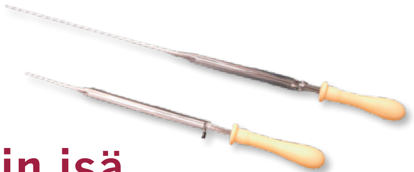
Pasteur-pipettien avulla siirretään nesteitä ja liuoksia astiasta toiseen.
