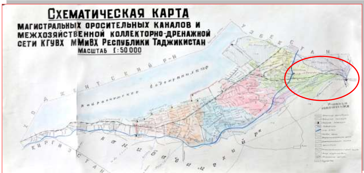
Рис. 3.9. Схематическая карта магистральных оросительных каналов и межхозяйственной КДС ГУМИ Канибадамского района.
