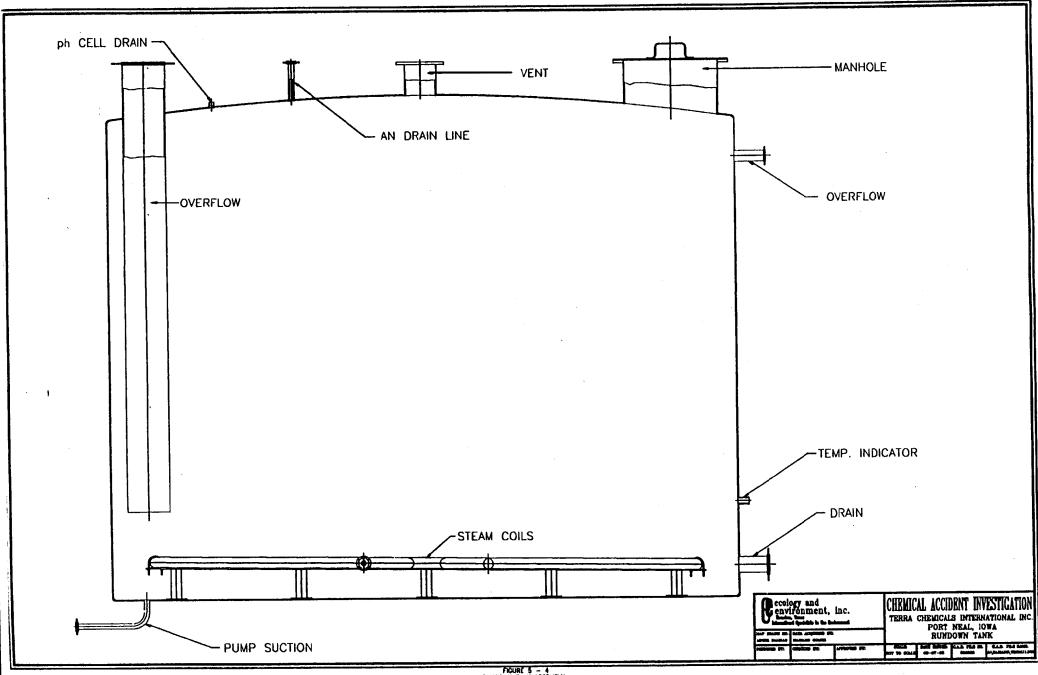
FIGURE 5 - 4 RUNDOWN TANK ASSEMBLY
