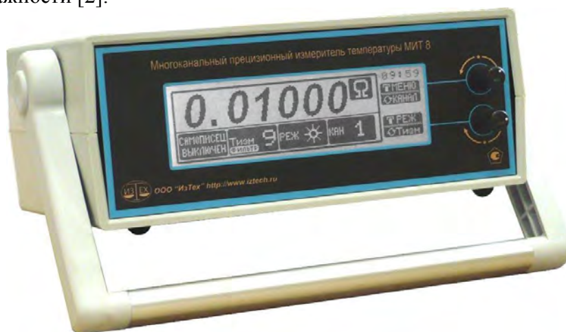
Рис. 1. Измеритель температуры многоканальный прецизионный МИТ 8.10 М
