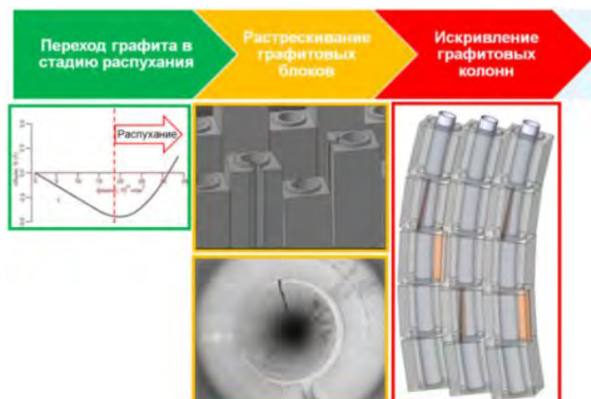
Рис. 1. Процесс формоизменения графитовой кладки
