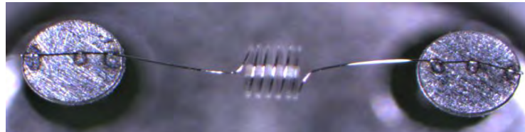
Рис. 9. Контактно-точечная сварка. Сенсор СТ-1
