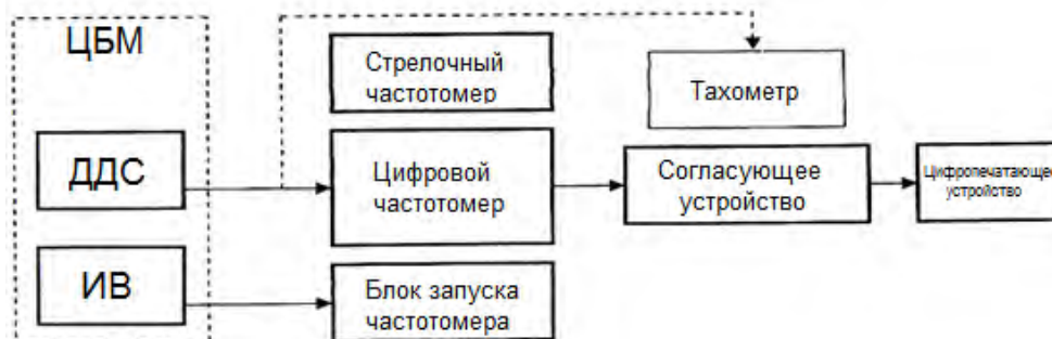
Рис. 2. Структурная схема измерения параметров линейного ускорения с применением частотомера
