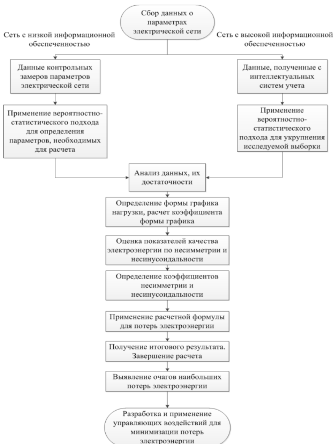
Рис. 2. Блок-схема, описывающая методику расчета потерь электроэнергии при несимметричной и несинусоидальной нагрузке
