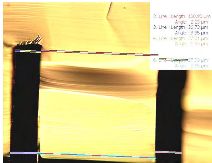
Рис. 5. Анализ профиля травления образцов гироскопа
