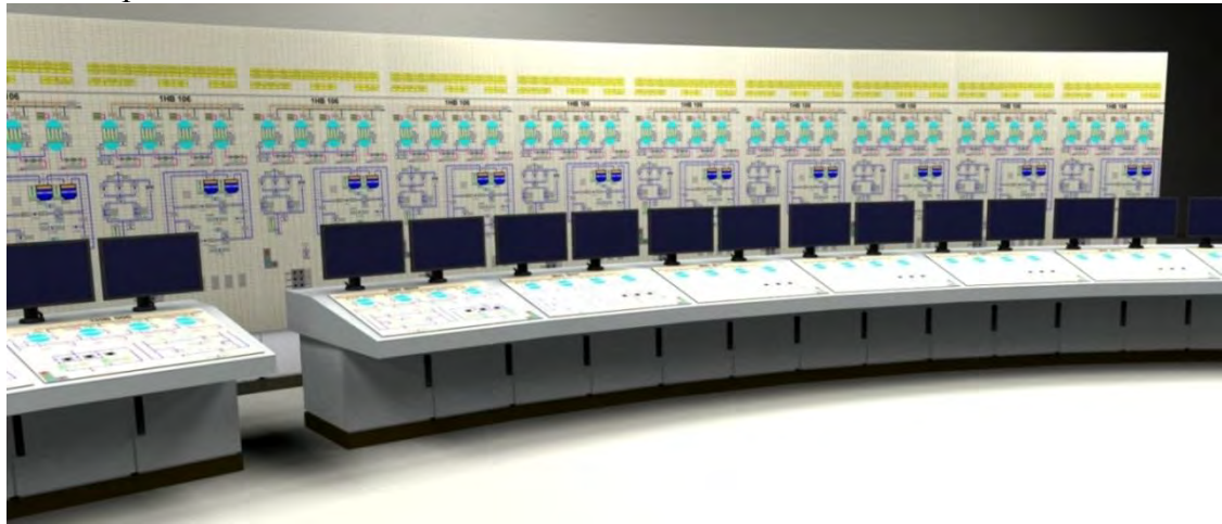
Рис. 2. Дизайн-проект БЩУ ЭБ №1 Калининской АЭС после модернизации
