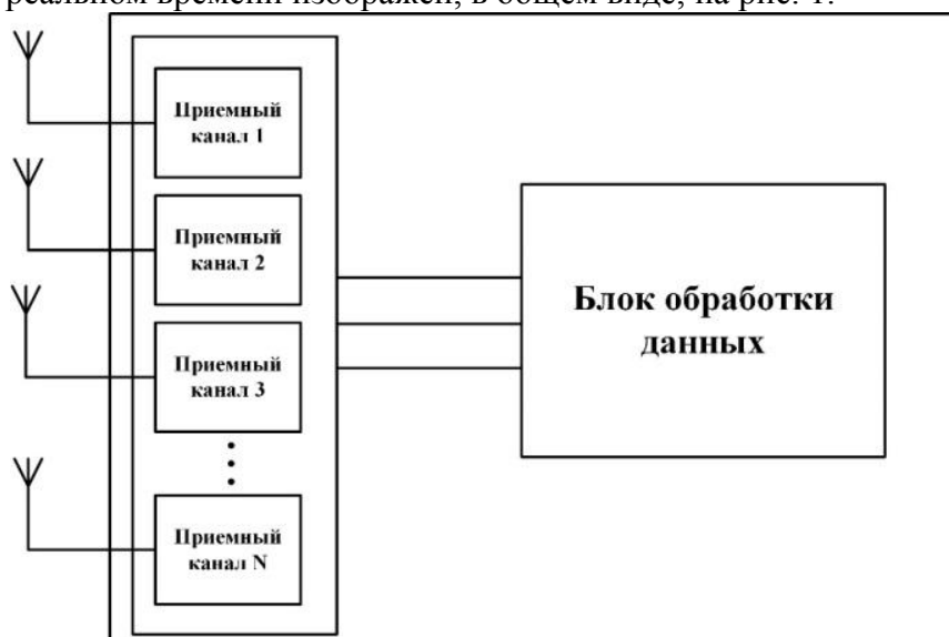
Рис.1. Устройство анализатора спектра СШП сигнала в реальном времени
