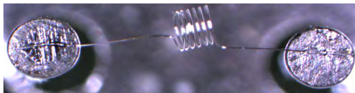
Рис. 7. Контактно-шовная сварка. Сенсор СТ-1
