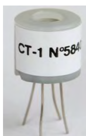
Рис. 3. Внешний вид сенсора СТ-1 в сборе
