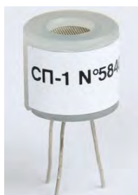
Рис. 6. Внешний вид сенсора СП-1 в сборе
