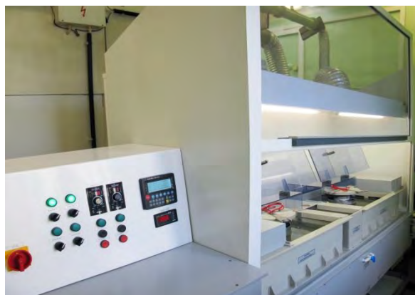
Рис. 2. Установка выращивания алюмооксидных слоев «Дельта-2/4. АНОКС-К»
