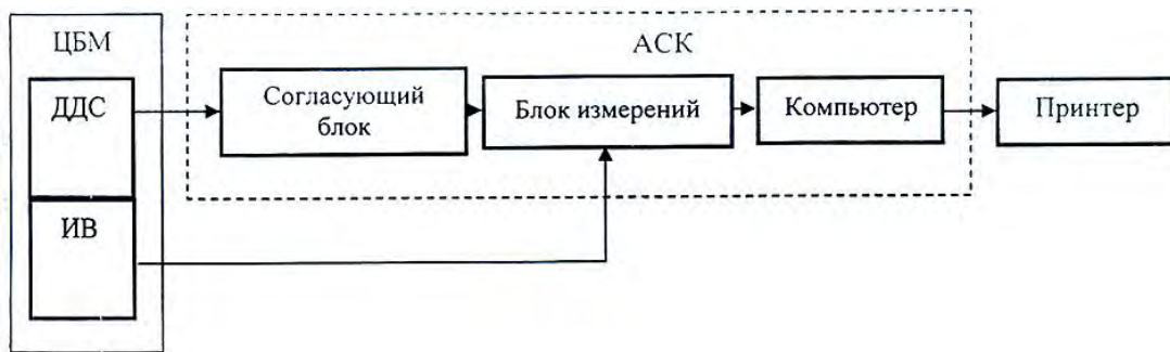
Рис. 1. Структурная схема измерения параметров линейного ускорения с применением АСК
