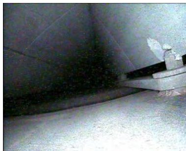
Рис. 4. Примеры истощения зазора «ГК-КЖ»
