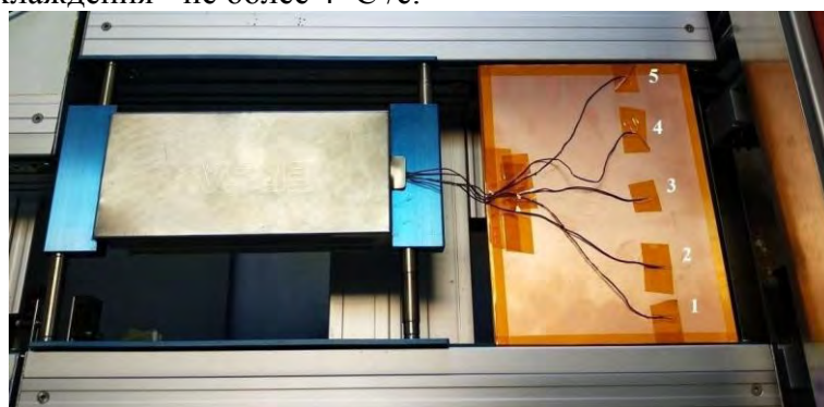
Рис. 1. Плата с МО с 5 термопарами и термопрофайлером на конвейере печи
