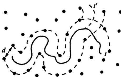
Рис. 8.11. Рептация цепи полимера. Цепь змееобразно движется по условной трубке
