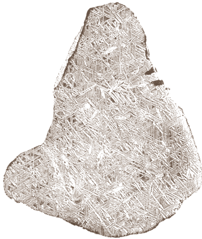
Рис. 3.4. Элбогенский железный метеорит, рассеченный, отполированный и протравленный. Рисунок выполнен с помощью пропитки протравленного сечения чернилами и использования его в качестве формы для печати. Изображение увеличено вдвое. Взято из опубликованной в 1820 году книги Карла фон Шрайберса, основанной на наблюдениях фон Видманшtedта в 1808 году (по Smith, 1960, p. 151). Микроструктура такого рода сейчас известна как структура Видманшtedта
