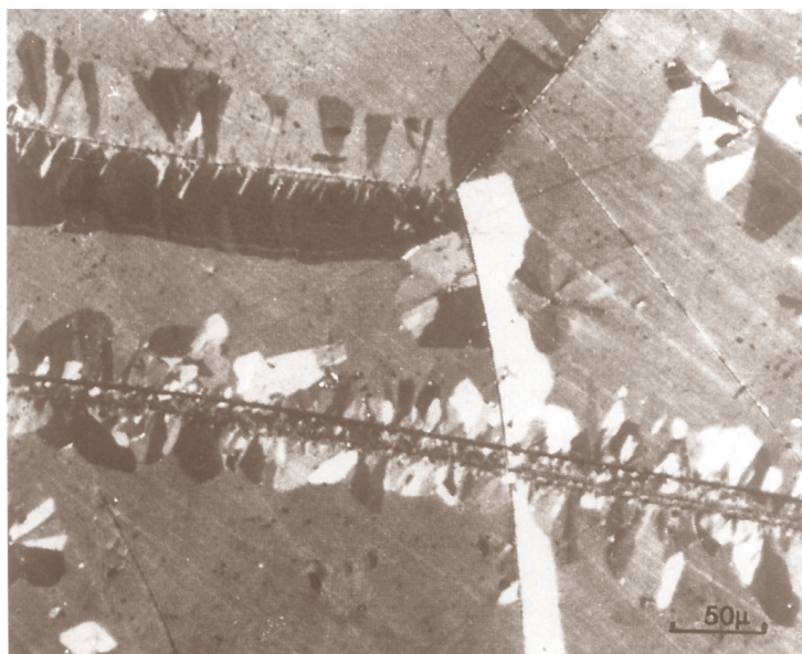
Рис. 6.2. Стехиометрическое соединение CuPt, выдержанное 157 часов при температуре 550°C. Фотография микроструктуры, сделанная в поляризованном свете. Виден рост доменов упорядоченной фазы гетерогенно зарождающихся на границах зерен и у царапин на поверхностях (по Irani and Cahn, 1973)
