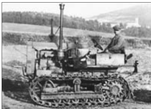
Pásový traktor značky Hanomag typ KG 48, výkon motoru 50 K. V pozadí zámek v Černé Hoře.
