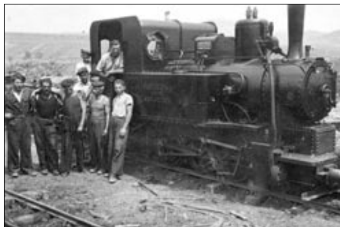
Lokomotiva typ 600-C-50 firmy Hrabě & Lozovský – výrobce ČKD, rok výroby 1939. Stavenišťe dálnice u Hlubokých Dvorů 1941
