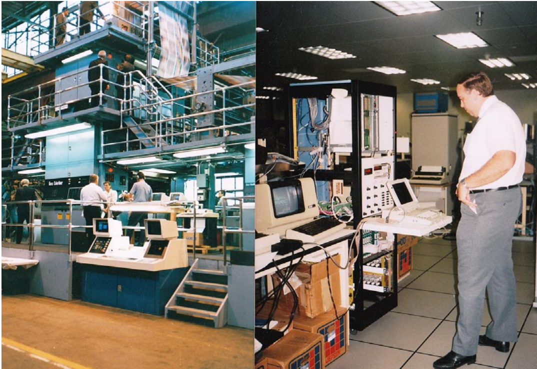
Während der Zeit, als Goss noch zum Rockwell-Konzern gehörte, betrieb man in Westmont, Illinois, ein aufwändig eingerichtetes Forschungs- und Entwicklungslabor – hier der Testlauf der Achterturm-Zeitungsrotation „Goss Colorliner“
