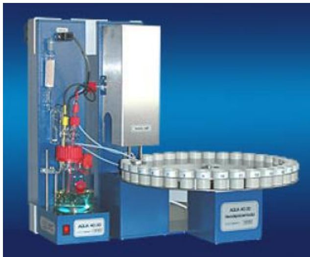
Abb. 7: Karl-Fischer-Titration zur Bestimmung des Wassergehaltes in der Farbe (Quelle: Analytik Jena AG)
