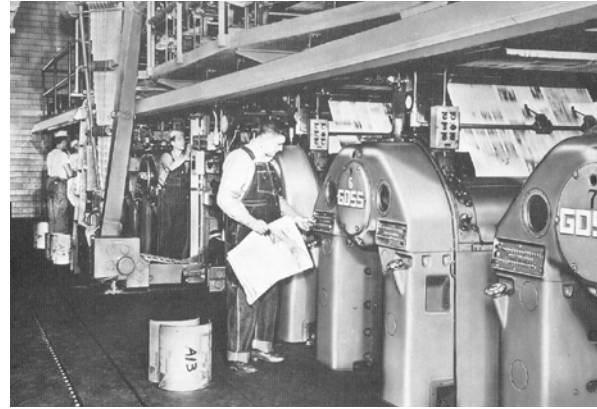
Diese GOSS-Headliner Buchdruck Zeitungsrotationsmaschinen lösten die Führungsposition der HOE-Maschinen nach dem Zweiten Weltkrieg ab und setzten diesen Erfolg auch bei den Offsetdruckmaschinen fort
