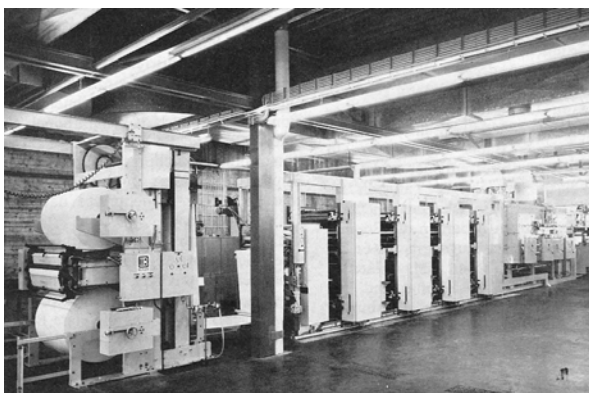
Mit dieser Akzidenz-Rollenoffsetdruckmaschine M-1000 wurde Harris 1975 Marktführer in dieser Kategorie von Druckmaschinen
