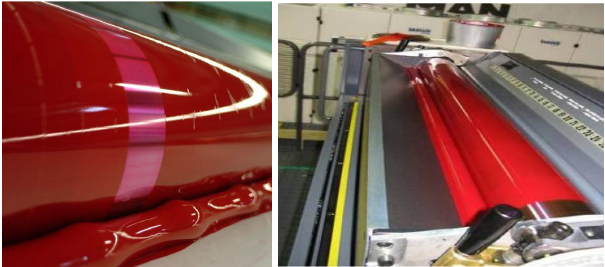
Abb. 4a und 4b: NANOCURE – Magenta im Farbkasten einer Bogenoffsetdruckmaschine
