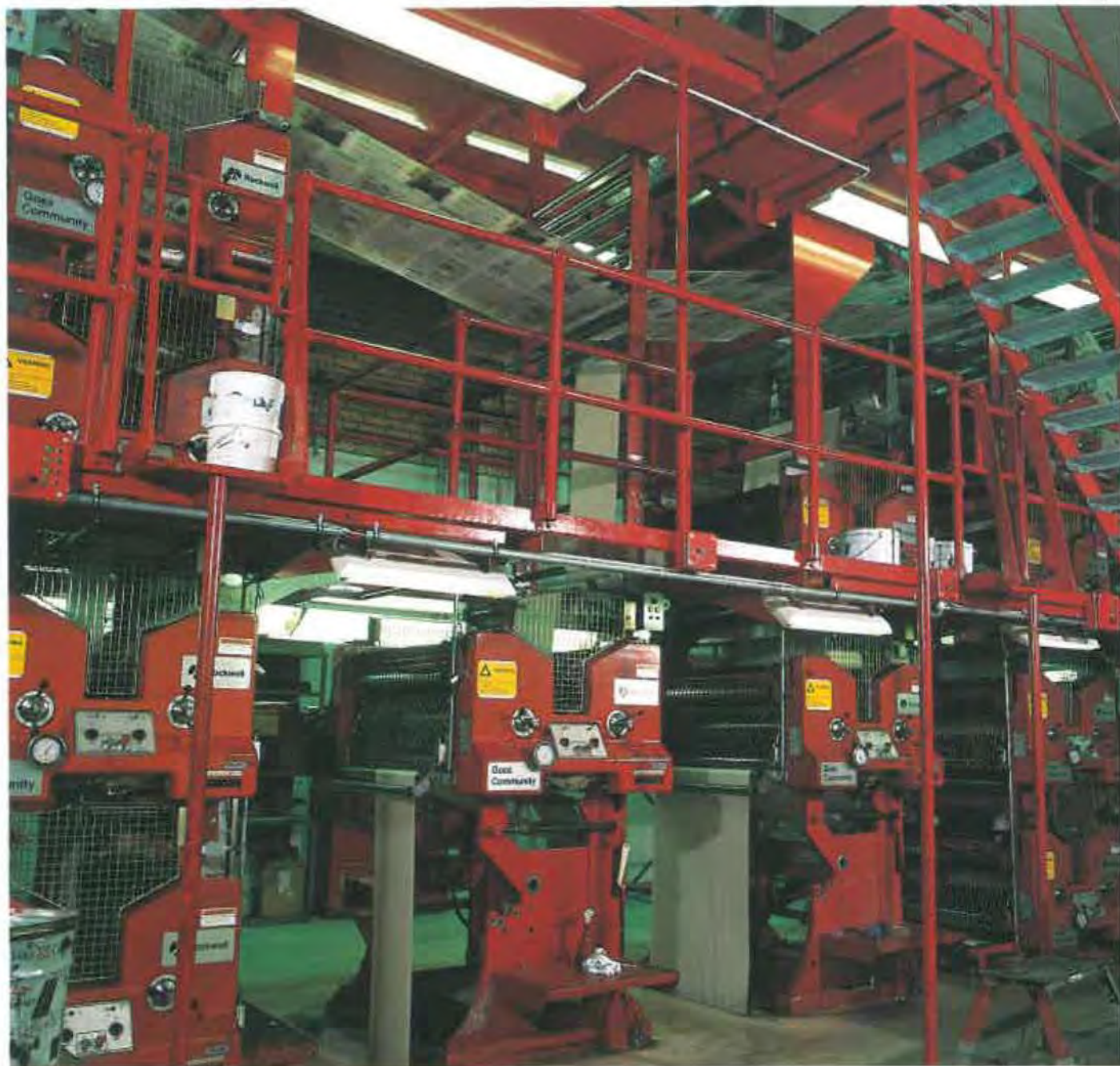
Den nya press av det amerikanska märket Goss Community, som 1990 installerats i Västerås passar för att trycka t ex ortstidningar i kvällsformat och reklamtryck av god kvalitet.
