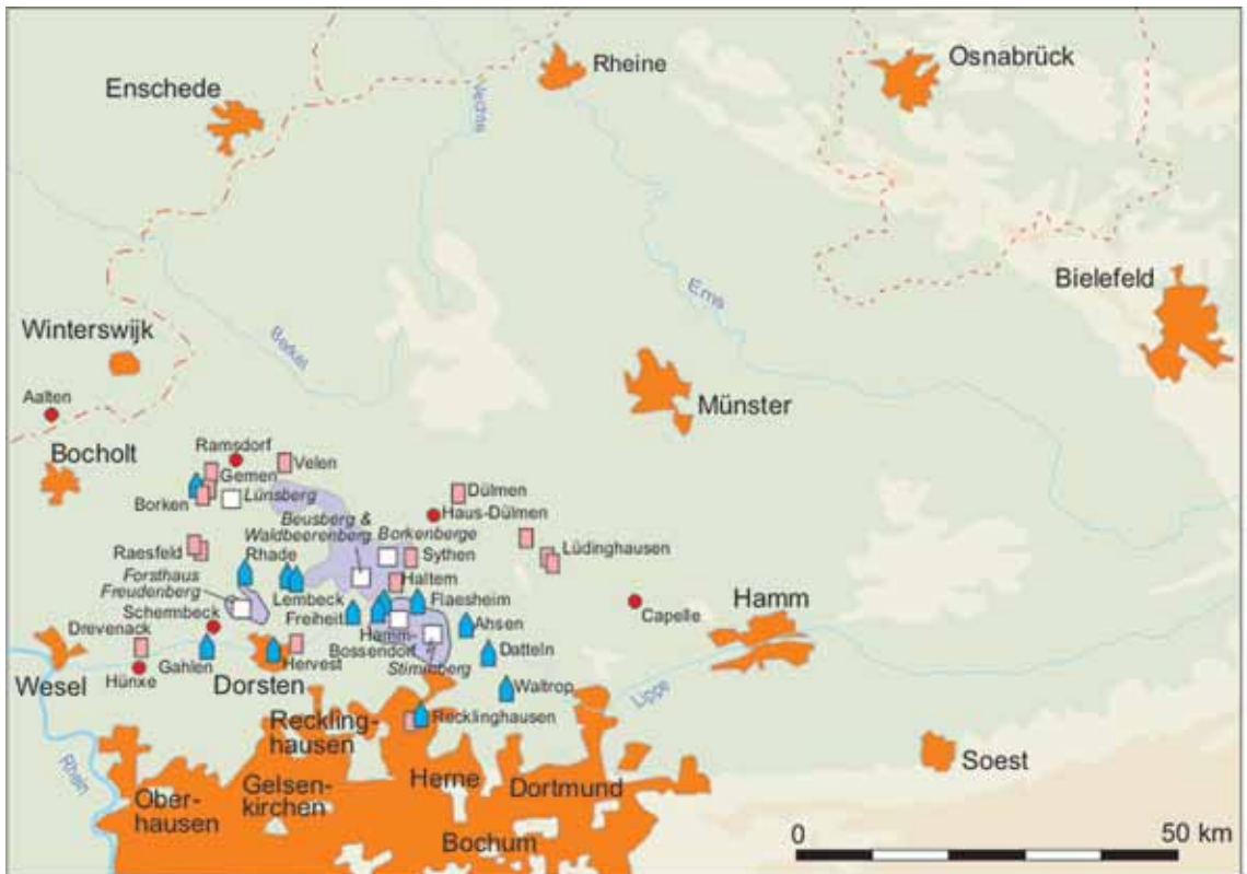
Abb. 32: Sandsteine der Haltern-Formation, geologisches Vorkommen und Verbreitung als Naturbaustein. ○ geologisches Vorkommen □ bekannte Abbaustellen von Sandsteinbänken, ▲ dominierend im Außenbereich, ■ nicht selten im Außenbereich, ● vereinzelt.
