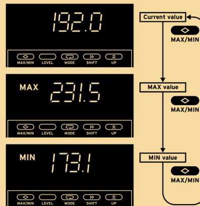
Para el control frecuente de valores de proceso máximos y mínimos, estos valores se pueden leer directamente pulsando el botón MAX/MIN. Al desconectarse la fuente de alimentación, el indicador se pone a cero.
