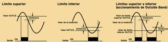
OUT1 y OUT2 pueden ajustarse para funcionar en cualquiera de los tres modos en función de los valores en comparación (aplicable sólo a los modelos con salida).
