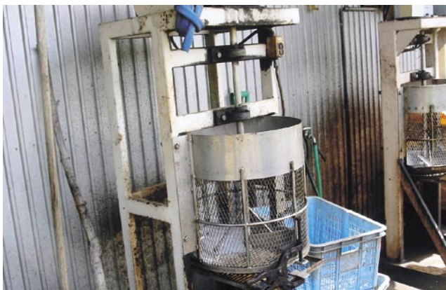
ギンナンの皮むき機。玉にして乾かすところまで機械化されている
