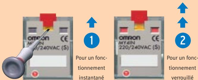
Mettez le bouton de test en position 1, puis appuyez sur le bouton jaune avec un outil isolé pour actionner le contact.
