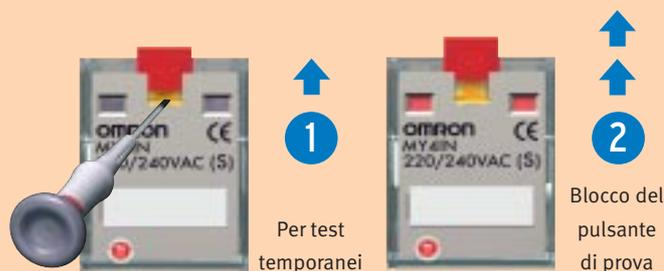
Spostare il pulsante di prova nella prima posizione, quindi applicare una pressione sul pulsante giallo utilizzando uno strumento isolato per fare scattare il contatto.
