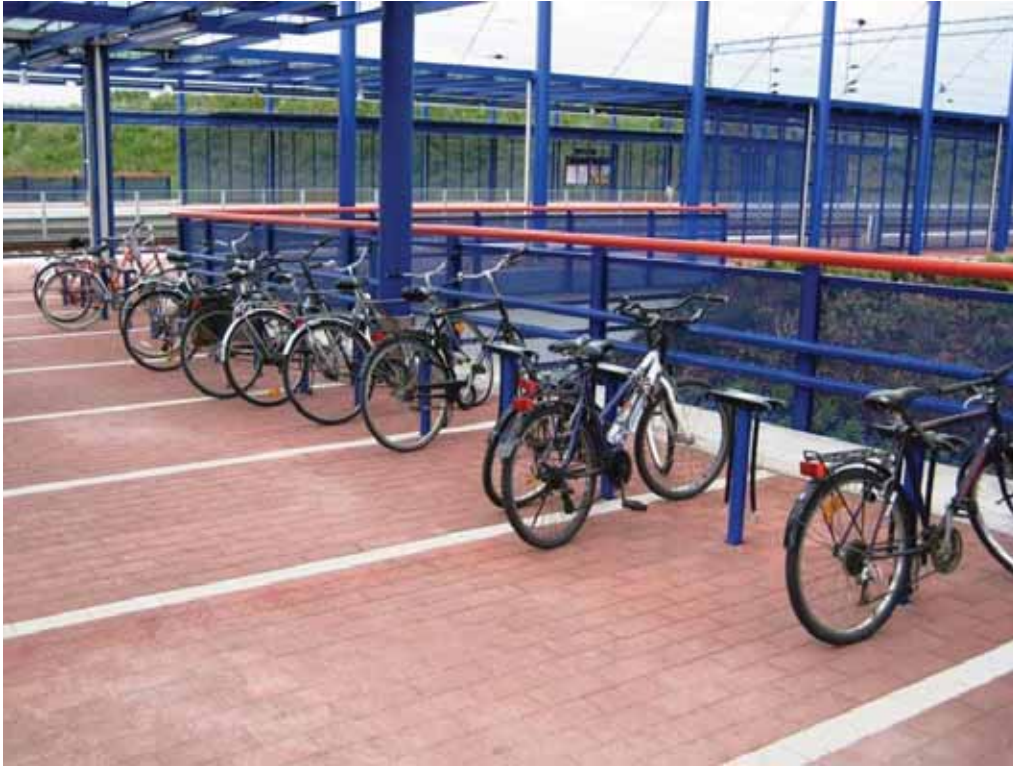
Kuva 26. Pyöräpaikoista vähintään 50 % tulee olla runkolukituspaikkoja (kuva Haarajoki).
