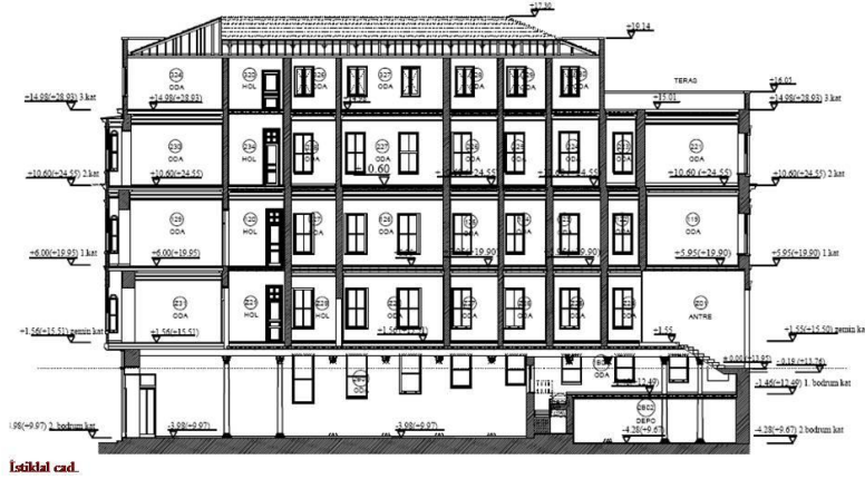
Şekil 5.21 : Katları gösteren kesit, restitüsyon projesi (HT ve Mimarlar).
