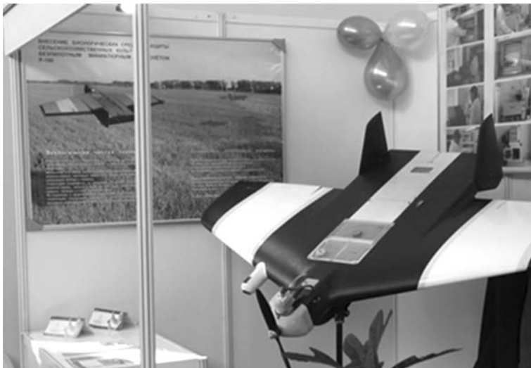
Рис. 4.3. Безпілотний літальний апарат R-100 для контрольованого розселення трихограми
