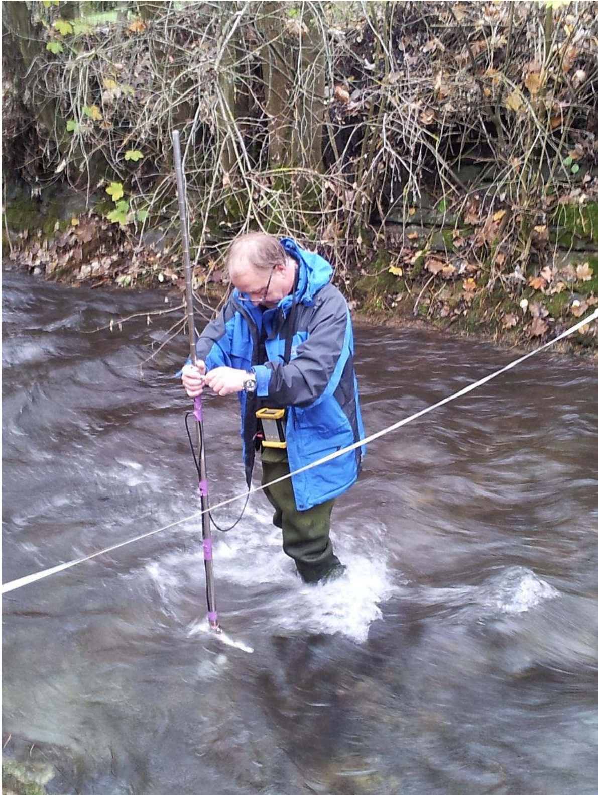
Abb. 66: Abflussmessung mit dem Messflügel an der Glanfurt (Foto: MOSER)
