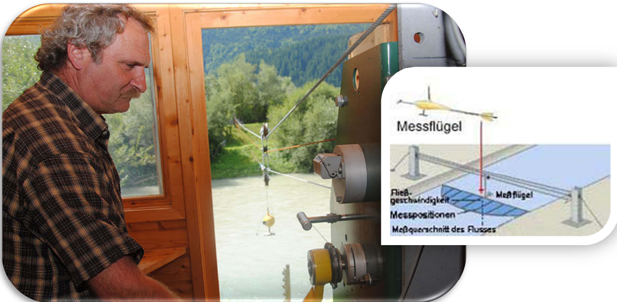
Abb. 63: Messtation Rattendorf mit Seilkrananlage und Messflügel (Foto: MALLE)
