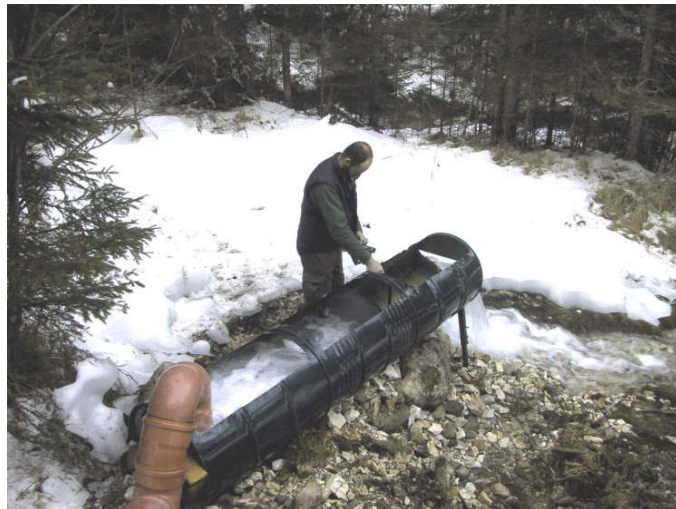
Abb. 87: Links: Quellstube (Wassertonne); Rechts: kreatives Messwehr aus Tonnen von Friedrich Gailberger (Fotos: JAUFER)
