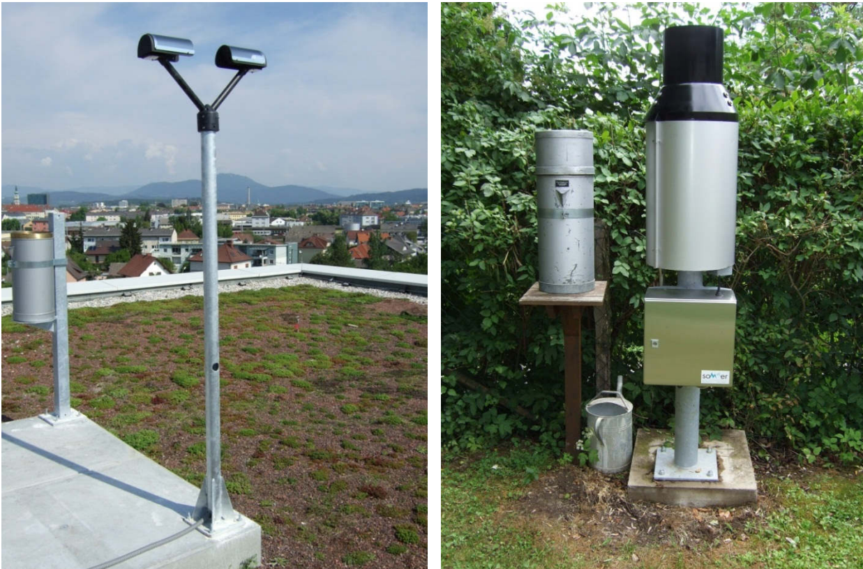
Abb. 28: Zur Messung des Niederschlages links: ein Distrometer, rechts: ein Ombrometer und ein Ombrograph (Fotos: LJUBA, WERNEGGER)
