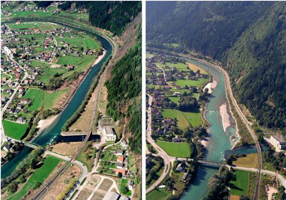
Abb. 170: Hochwasserschutzmaßnahmen an der Drau in Sachsenburg. Bild links: vor der Maßnahme. Bild rechts: Naturnahe Schutzmaßnahmen durch Aufweitungen und Dämme (Schutzwasserwirtschaft Kärnten)
