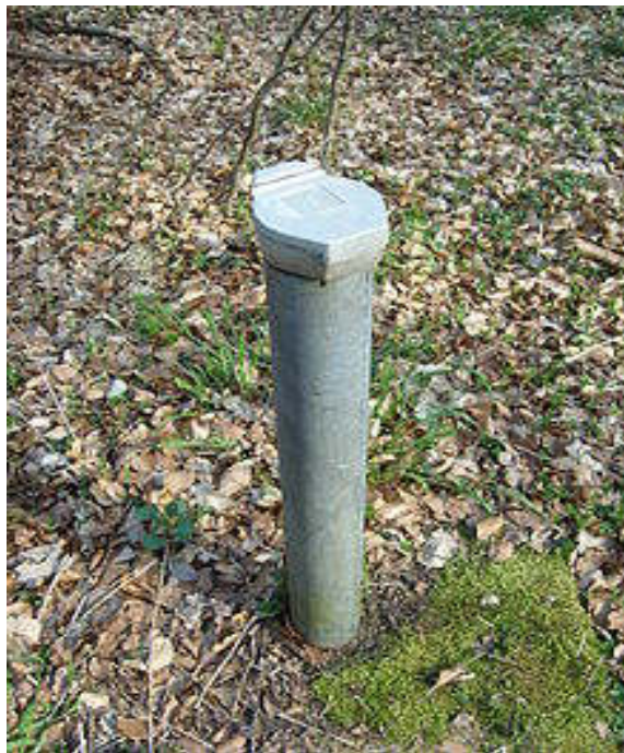
Abb. 91: Überflur-Grundwassermessstelle: 1=Kappe, 2=Aufsatzrohr, 3=Filterrohr, 4=Sumpfrohr, 5=Betonabdeckung, 6=frostsicherer Boden, 7=Abdichtung, 8=Bohrgut, 9=Filtersand (Vgl. GeoLexikon)
