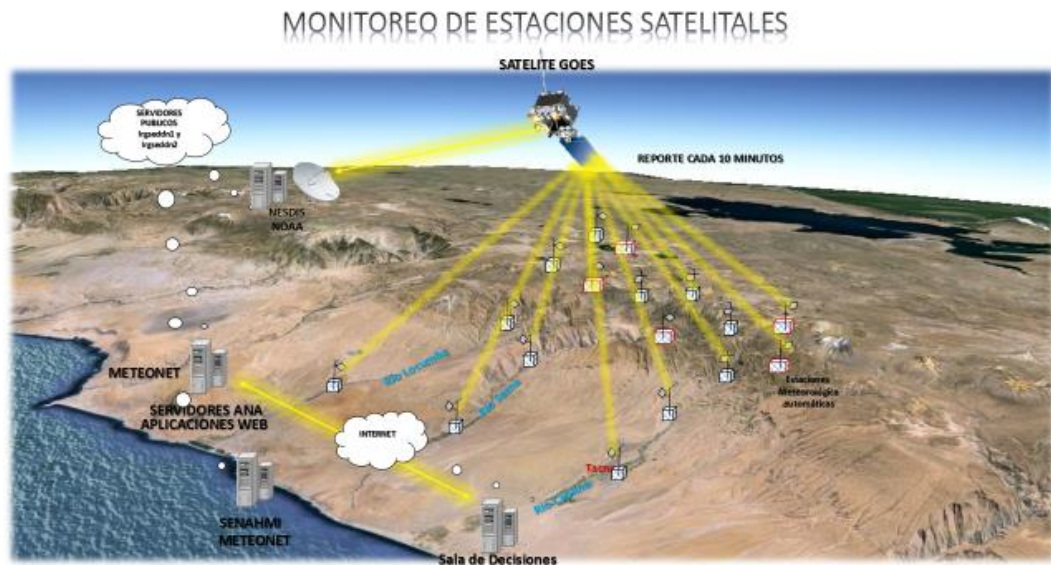
Figura No. 2-8 Monitoreo Satelital de Estaciones Automáticas
